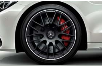
AMG19インチクロススポーク鍛造アルミホイール (マットブラック/ハイシーズンリムフランジ)
