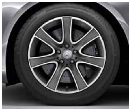
Llanta de aleación de 7 radios, neumáticos 245/50 R 18 delante y 275/45 R 18 detrás (código R72) (no disponible para el mercado español).
