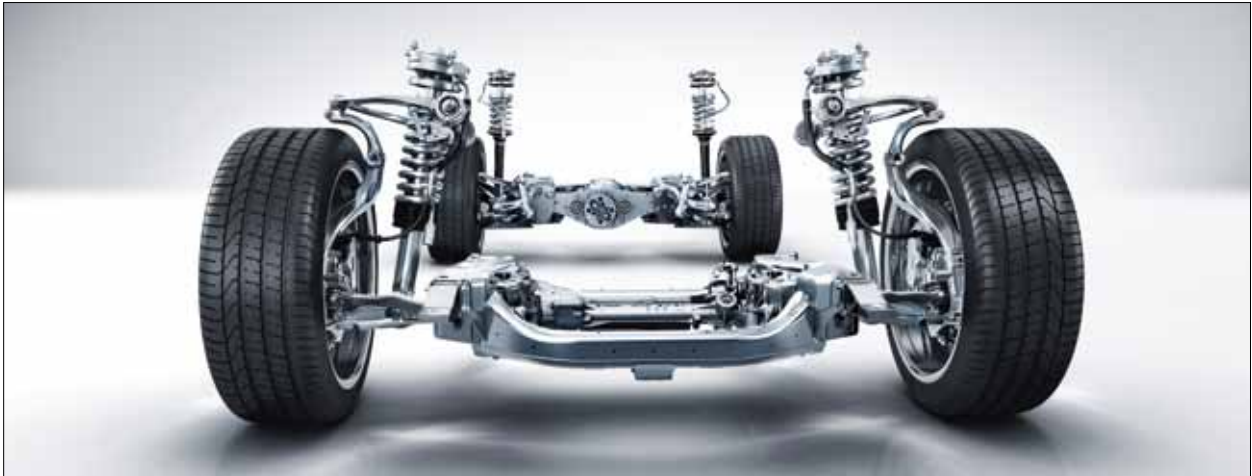
El sistema de suspensión neumática semiactiva integral AIRMATIC con regulación progresiva de la amortiguación conjuga un elevado confort de suspensión y de rodadura con un excelente dinamismo de conducción.
