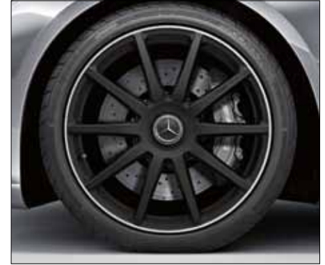
Llanta forjada AMG en diseño de 10 radios, color negro mate con pestaña de la llanta pulida a alto brillo, neumáticos 255/40 R 20 delante y 285/35 R 20 detrás (código 648). Opcional para modelos Mercedes-AMG.
