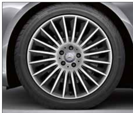
Llanta de aleación en diseño multirradio, color plata vanadio, neumáticos 245/45 R 19 delante y 275/40 R 19 detrás (código 11R).
