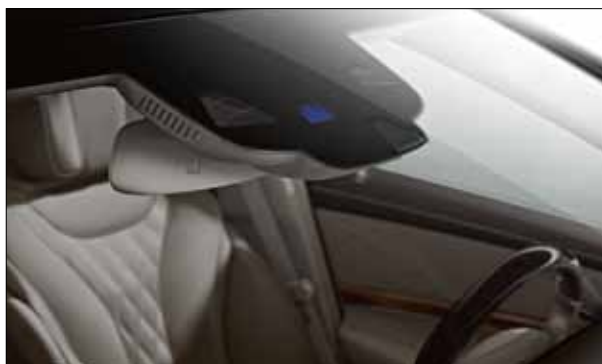
Con ayuda de la cámara estereoscópica se explora y se evalúa permanentemente la situación en el entorno por delante del vehículo.
