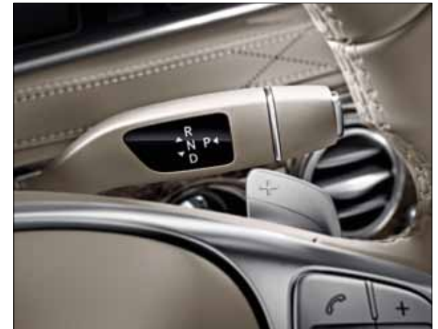
Palanca selectora DIRECT SELECT en el volante. Mediante las levas, el conductor puede cambiar manualmente a una marcha superior o inferior.
