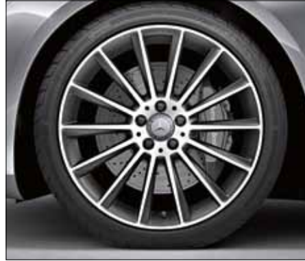
Llanta de aleación AMG en diseño multirradio color gris titanio y pulida a alto brillo, neumáticos 245/40 R 20 delante y 275/35 R 20 detrás (código 769).
