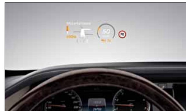
El Head-up-Display muestra información importante directamente en su campo visual.
