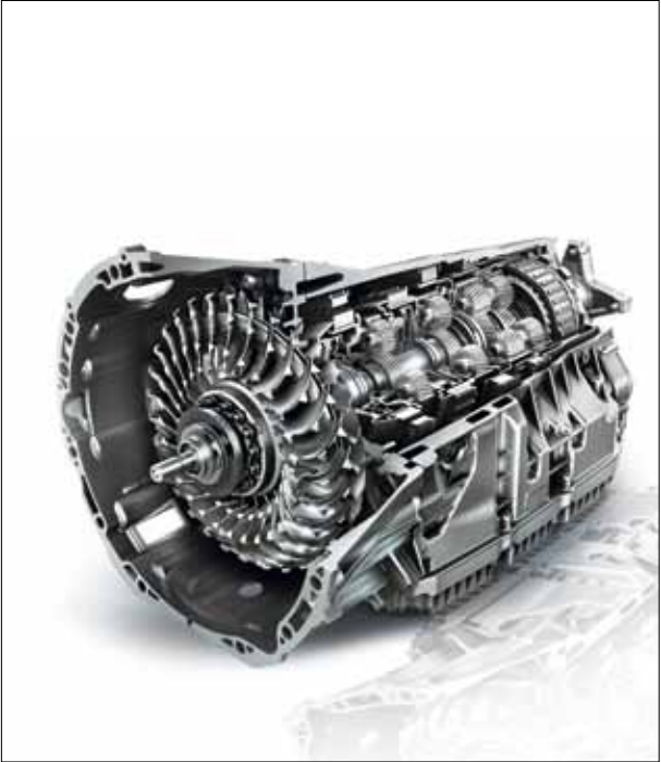
La transmisión automática de nueve velocidades con convertidor de par 9G-TRONIC permite cambios de relación especialmente suaves gracias al corto tiempo de respuesta y a la rapidez en los acoplamientos.
