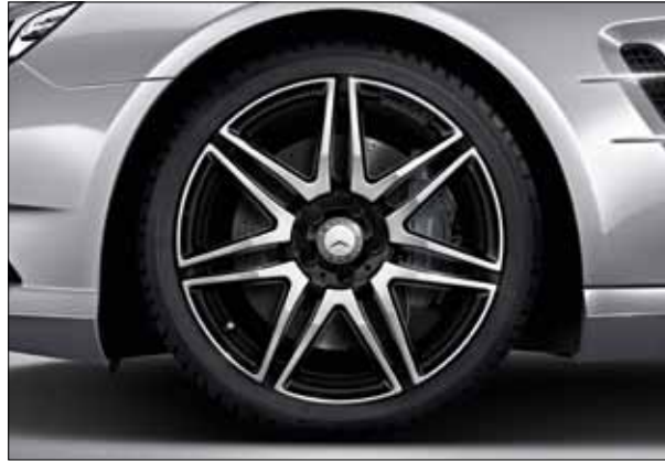
Zeven-dubbelspaaks lichtmetalen AMG-velgen, hoogglanzend zwart en glanzend, met banden 255/35 R19 voor en 285/30 R19 achter (optie, onderdeel van AMG Line, code 662).
