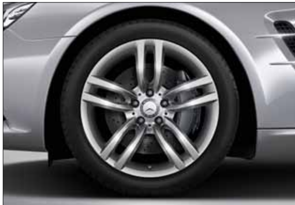
Vijf-dubbelspaaks lichtmetalen velgen, vanadiumsilver, met banden 255/40 R18 voor en 285/35 R18 achter (optie, code R70).
