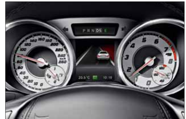
De spoorassistent waarschuwt de bestuurder met een licht vibrerend stuurwiel wanneer onbedoeld van rijstrook wordt gewisseld.
