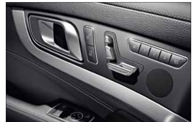
De standaard, elektrisch bedienbare stoelverstelling met memoryfunctie.
