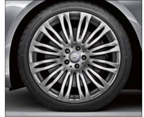
Leichtmetallrad im Vielspeichen-Design, thuliumsilber lackiert, mit Bereifung 245/40 R 20 vorne und 275/35 R 20 hinten (Code 13R).
