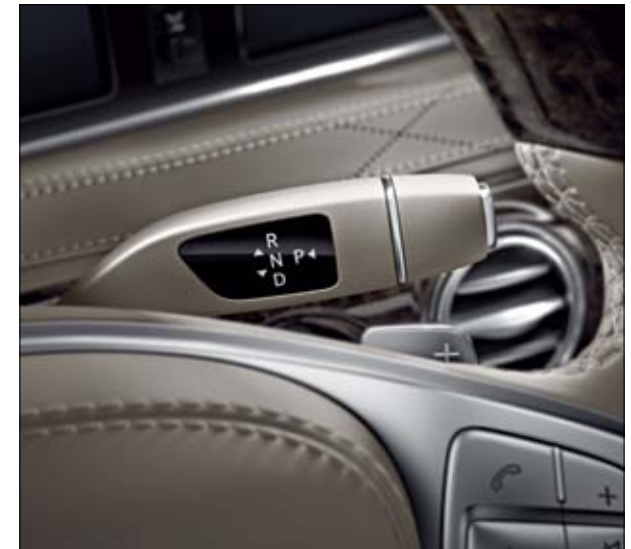
DIRECT SELECT Wählhebel am Lenkrad. Per zusätzlichen Schaltpaddles kann der Fahrer auch manuell hoch- oder runterschalten.
