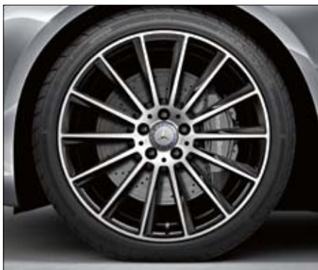
AMG Leichtmetallrad im Vielspeichen-Design, hochglanzschwarz lackiert und glanzgedreht, mit Bereifung 245/40 R 20 vorne und 275/35 R 20 hinten (nur in Verbindung mit AMG Line Plus, Code 789).
