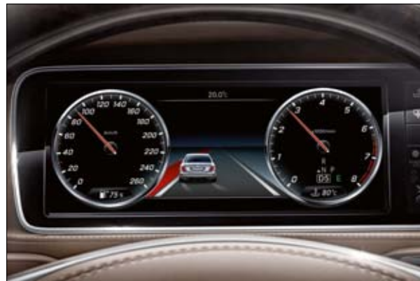
Der Aktive Spurhalte-Assistent kann bei unbeabsichtigtem Verlassen der Fahrspur spurkorrigierend eingreifen.
