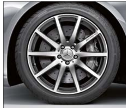
AMG Schmiederad im 10-Speichen-Design, titangrau lackiert und poliert, mit Bereifung 255/45 R 19 vorne und 285/40 R 19 hinten (Serie für S 63 AMG und S 63 AMG 4MATIC, Code 788).
