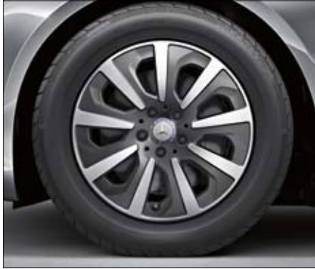
Leichtmetallrad im 9-Speichen-Design, tremolit-metallic lackiert und glanzgedreht, mit Bereifung 245/55 R 17 (Code 09R).
