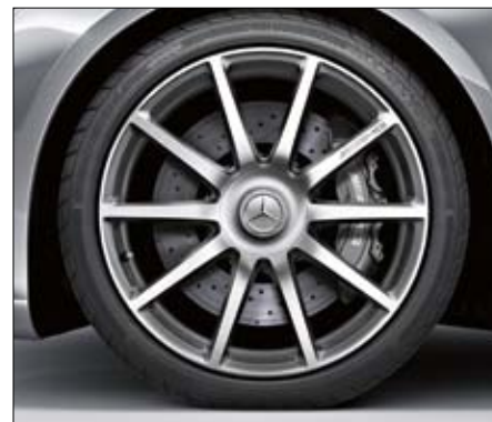
AMG Schmiederad im 10-Speichen-Design, titangrau lackiert und poliert, mit Bereifung 255/40 R 20 vorne und 285/35 R 20 hinten (nur für S 63 AMG, S 63 AMG 4MATIC und S 65 AMG, Code 647).
