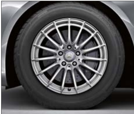
Leichtmetallrad im Vielspeichen-Design, vanadiumsilber lackiert, mit Bereifung 245/55 R 17 (Code 08R).
