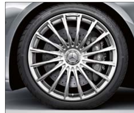
AMG Schmiederad im Vielspeichen-Design, keramisch hochglanzpoliert, mit Bereifung 255/40 R 20 vorne und 285/35 R 20 hinten (nur für S 65 AMG, Code 696).
