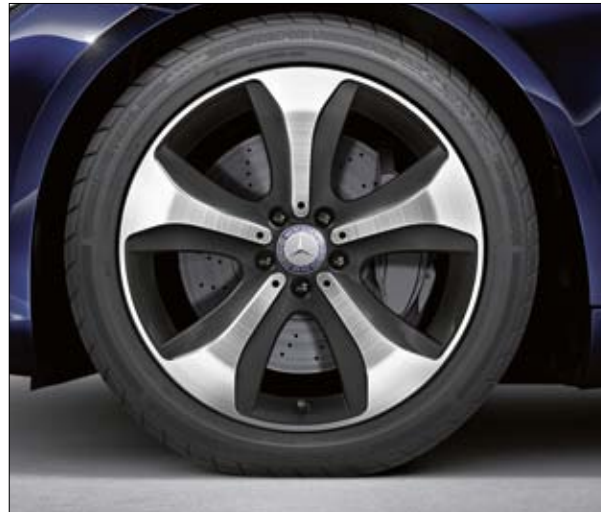
19 Zoll Leichtmetallrad im 5-Speichen-Design mit der Bereifung 245/45 R 19 vorne und 275/40 R 19 hinten.
