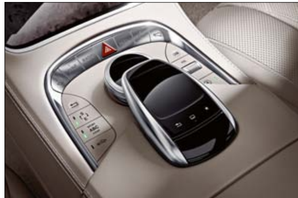
Das Touchpad erlaubt die bequeme Steuerung von Telematikfunktionen mit einem oder zwei Fingern.
