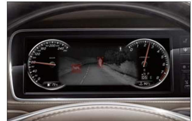
Der Nachtsicht-Assistent Plus hebt erkannte Personen optisch hervor und hilft dem Fahrer, bei Dunkelheit schneller auf Gefahren zu reagieren.
