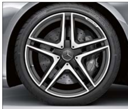
AMG Schmiederad im 5-Doppelspeichen-Design, titangrau lackiert und poliert, mit Bereifung 255/40 R 20 vorne und 285/35 R 20 hinten (nur für S 63 AMG, S 63 AMG 4MATIC und S 65 AMG, Code 753).
