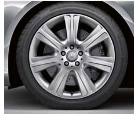
Leichtmetallrad im 7-Dreifachspeichen-Design, vanadiumsilber lackiert, mit Bereifung 245/45 R 19 vorne und 275/40 R 19 hinten (Code 12R).
