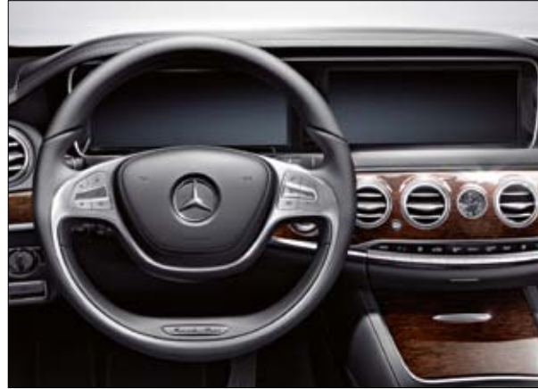
Multifunktionslenkrad in Leder Nappa, im 2-Speichen-Design, mit 12 Tasten.
