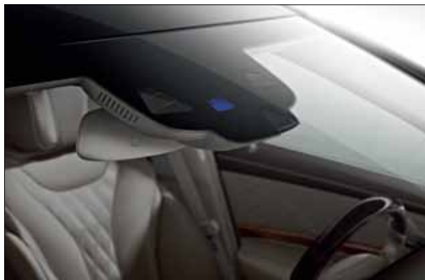
La caméra stéréo scrute et analyse en permanence la situation en amont du véhicule.
