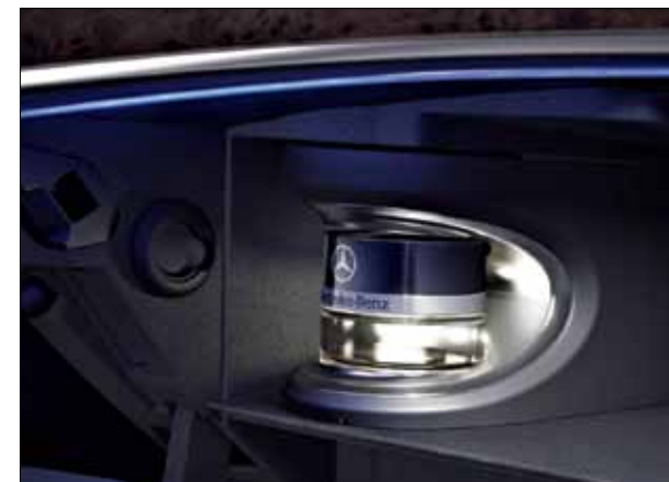
Pack AIR-BALANCE avec ionisation, filtrage de l'air et diffusion de parfum.
