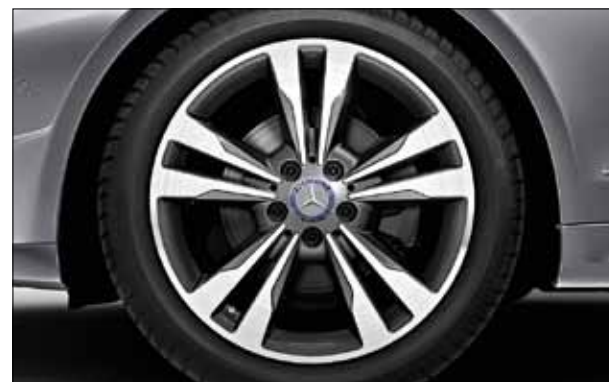
Llanta de aleación de 5 radios dobles con neumáticos 235/40 R 18 delante y 255/35 R 18 detrás (código 22R, opcional).
