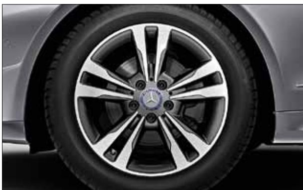
Llanta de aleación de 5 radios dobles con neumáticos 235/45 R 17 (código 44R, de serie para modelos de 4 y 6 cilindros).
