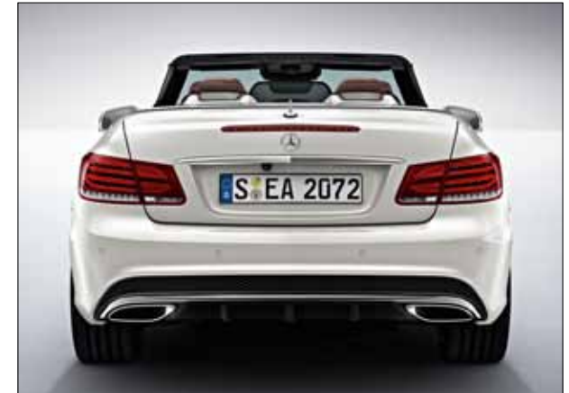
El paquete deportivo AMG ofrece igualmente un equipo de escape de doble flujo con embellecedores trapezoidales de acero inoxidable pulido en el paragolpes.
