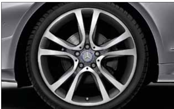
Llanta de aleación de 5 radios dobles con neumáticos 235/35 R 19 delante y 255/30 R 19 detrás (código R17, opcional).
