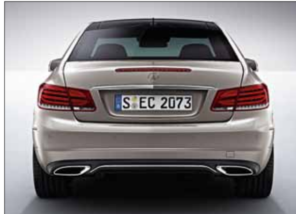
El paquete deportivo exterior incluye un equipo de escape de doble flujo y embellecedores trapezoidales de acero inoxidable pulido en el paragolpes.
