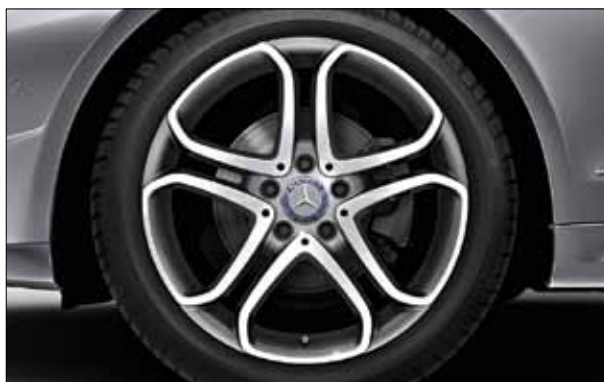
Llanta de aleación de 5 radios dobles con neumáticos 235/40 R 18 delante y 255/35 R 18 detrás (código R71, opcional).
