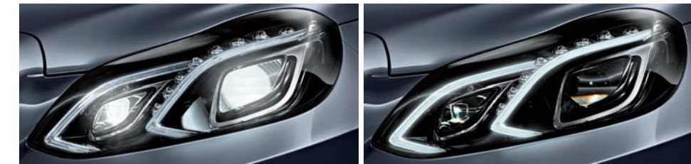
インテリジェントライトシステムを搭載した LEDハイパフォーマンスヘッドライト
