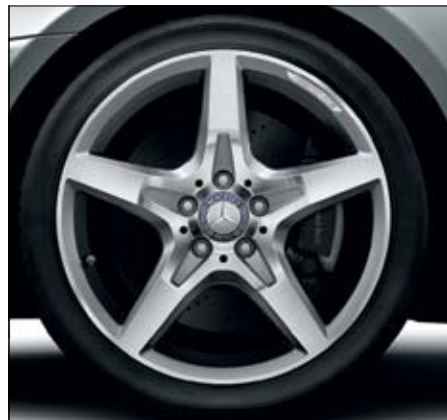
AMG Leichtmetallrad im 5-Speichen-Design, glanzgedreht, mit Bereifung 225/40 R 18 vorne und 245/35 R 18 hinten (AMG Line, Code 782).
