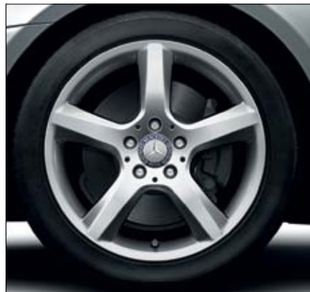
Leichtmetallrad im 5-Speichen-Design mit Bereifung 225/45 R 17 vorne und 245/40 R 17 hinten (Serie für SLK 250, Code 37R).
