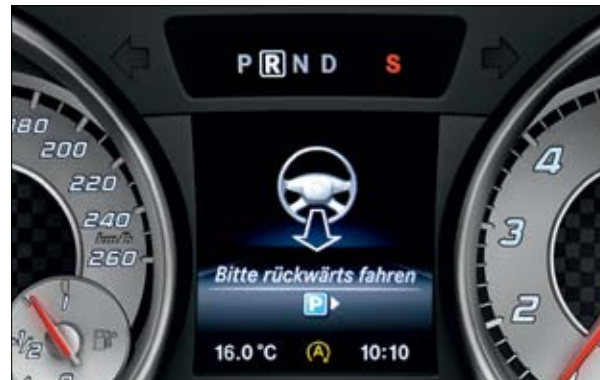
Die Parkführung zeigt dem Fahrer geeignete Parklücken an und gibt Hinweise zum Einparken.
