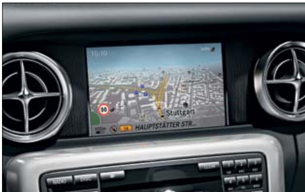
Die Anzeige des Geschwindigkeitslimit-Assistenten erfolgt sowohl im Kombiinstrument als auch im zentralen Display des COMAND Online.
