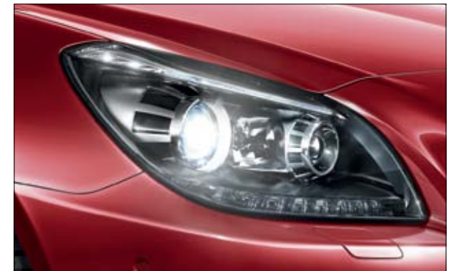
Das Intelligent Light System passt sich den Wetter-, Licht- und Fahrbedingungen automatisch an.
