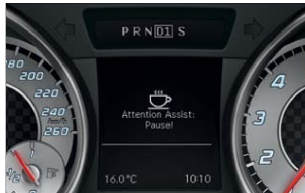
Erkennt der ATTENTION ASSIST Anzeichen von Müdigkeit beim Fahrer, empfiehlt das System eine Pause.
