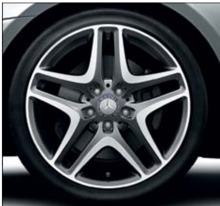
Leichtmetallrad im 5-Doppelspeichen-Design, palladium-silber lackiert, glanzgedreht, mit Bereifung 225/40 R 18 vorne und 245/35 R 18 hinten (Option, Code 22R).
