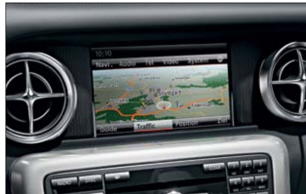
Ein hochauflösendes 17,8 cm großes Farbdisplay ist Bestandteil des optionalen COMAND Online und sorgt für gute Übersicht über alle Systemfunktionen.
