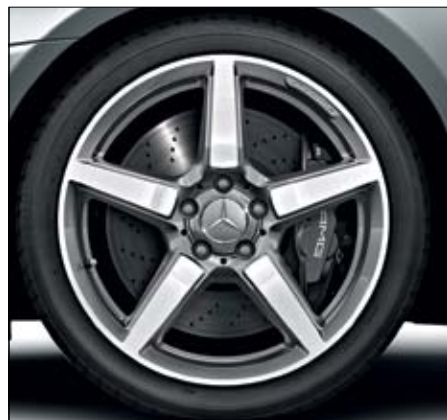
AMG Leichtmetallrad im 5-Speichen-Design, titangrau lackiert, glanzgedreht, mit Bereifung 235/40 R 18 vorne und 255/35 R 18 hinten (Serie für SLK 55 AMG, Code 790).
