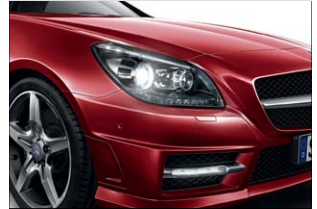
Intelligent Light System mit LED-Tagfahrlicht.
