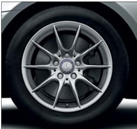
Leichtmetallrad im 10-Speichen-Design mit Bereifung 205/55 R 16 (Serie für SLK 200, Code 39R).
