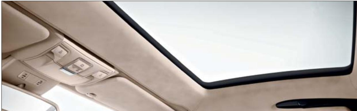
**Panorama-Variodach mit MAGIC SKY CONTROL** (Option). Das Panorama-Variodach mit MAGIC SKY CONTROL ist eine Innovation von Mercedes-Benz. Die durchsichtige Scheibe des Dachs verfärbt sich auf Knopfdruck innerhalb weniger Sekunden von dunkel zu transparent oder umgekehrt. Dadurch können Fahrer und Beifahrer auch bei geschlossenem Dach den Himmel genießen. In getöntem Zustand wird zudem die Aufheizung des Innenraums maßgeblich reduziert.
