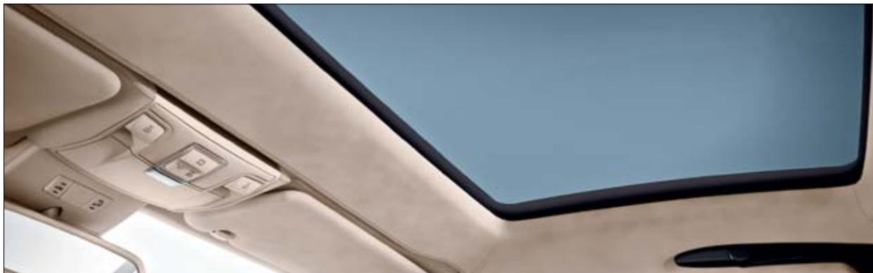
**Variodach** (Serie). Das vollelektrisch versenkbare Variodach verwandelt den SL auf Knopfdruck von einem Coupé in einen offenen Roadster. Zum Öffnen oder Schließen vergehen weniger als 20 Sekunden. Das Dach kann serienmäßig auch von außen mithilfe des Fahrzeugschlüssels via Funksignal geschlossen oder geöffnet werden. Und das so platzsparend, dass selbst bei offenem Dach noch bis zu 241 Liter Kofferraumvolumen zur Verfügung stehen.
