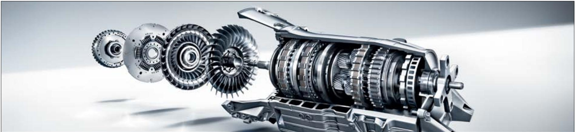
Die 7G-TRONIC PLUS: eines von über 19 Millionen produzierten Automatikgetrieben in mehr als 50 Jahren.
