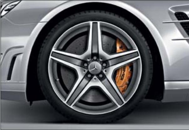
AMG Leichtmetallrad im 5-Speichen-Design, titangrau lackiert und glanzgedreht, mit Bereifung 255/35 R 19 vorne und 285/30 R 19 hinten (Serie für SL 65 AMG, Code 797).
