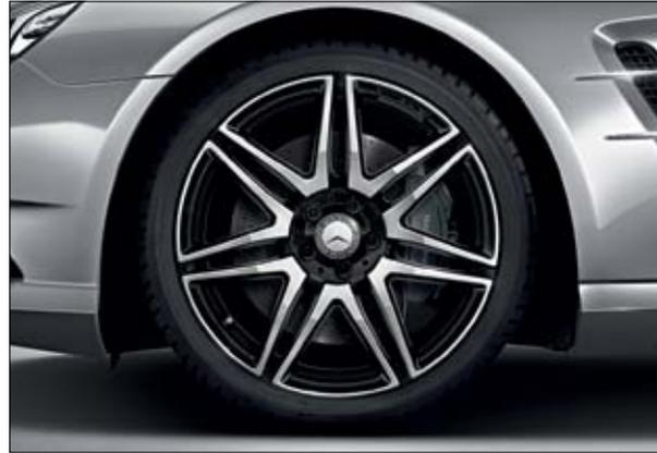
AMG Leichtmetallrad im 7-Doppelspeichen-Design, hochglanzschwarz lackiert und glanzgedreht, mit Bereifung 255/35 R 19 vorne und 285/30 R 19 hinten (optional, Bestandteil AMG Line, Code 662).
