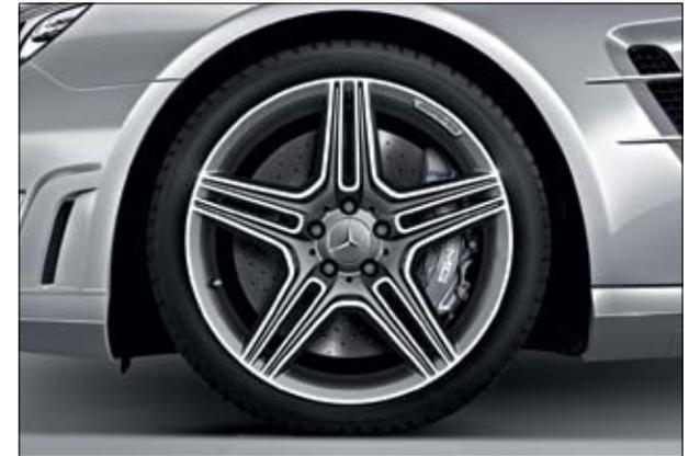
AMG Leichtmetallrad im 5-Doppelspeichen-Design, titangrau lackiert und glanzgedreht, mit Bereifung 255/35 R 19 vorne und 285/30 R 19 hinten (Serie für SL 63 AMG, Code 793).
