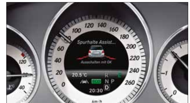
Der Aktive Spurhalte-Assistent kann mit Lenkradvibrationen warnen und sogar gegensteuern, wenn der Fahrer unbeabsichtigt von der Fahrbahn abkommt.
