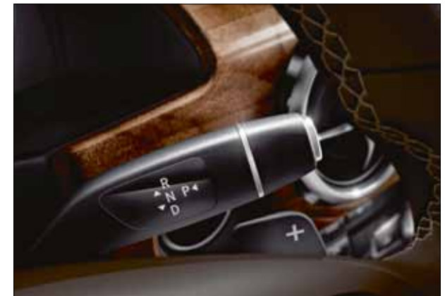
Getriebebedienung mit dem DIRECT SELECT Wählhebel am Lenkrad. Über die Schalt paddles am Lenkrad kann der Fahrer die Schaltvorgänge beeinflussen.
