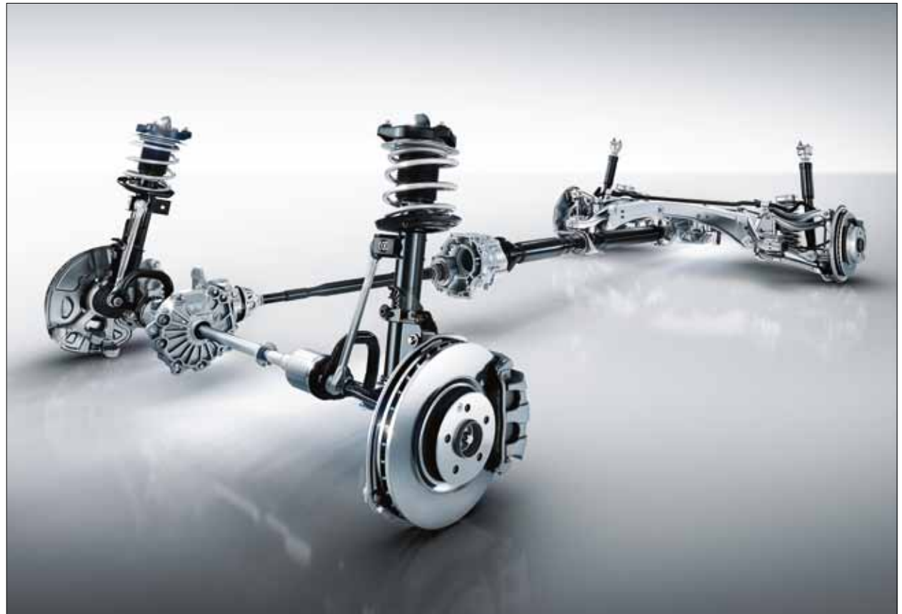
Das AGILITY CONTROL Fahrwerk mit selektivem Dämpfungssystem stellt sich schnell und präzise auf Fahrgeschwindigkeit und -situation sowie den Untergrund ein.
