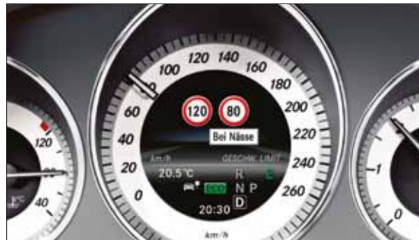
Der Geschwindigkeitslimit-Assistent kann auch temporäre Geschwindigkeitsbeschränkungen anzeigen.
