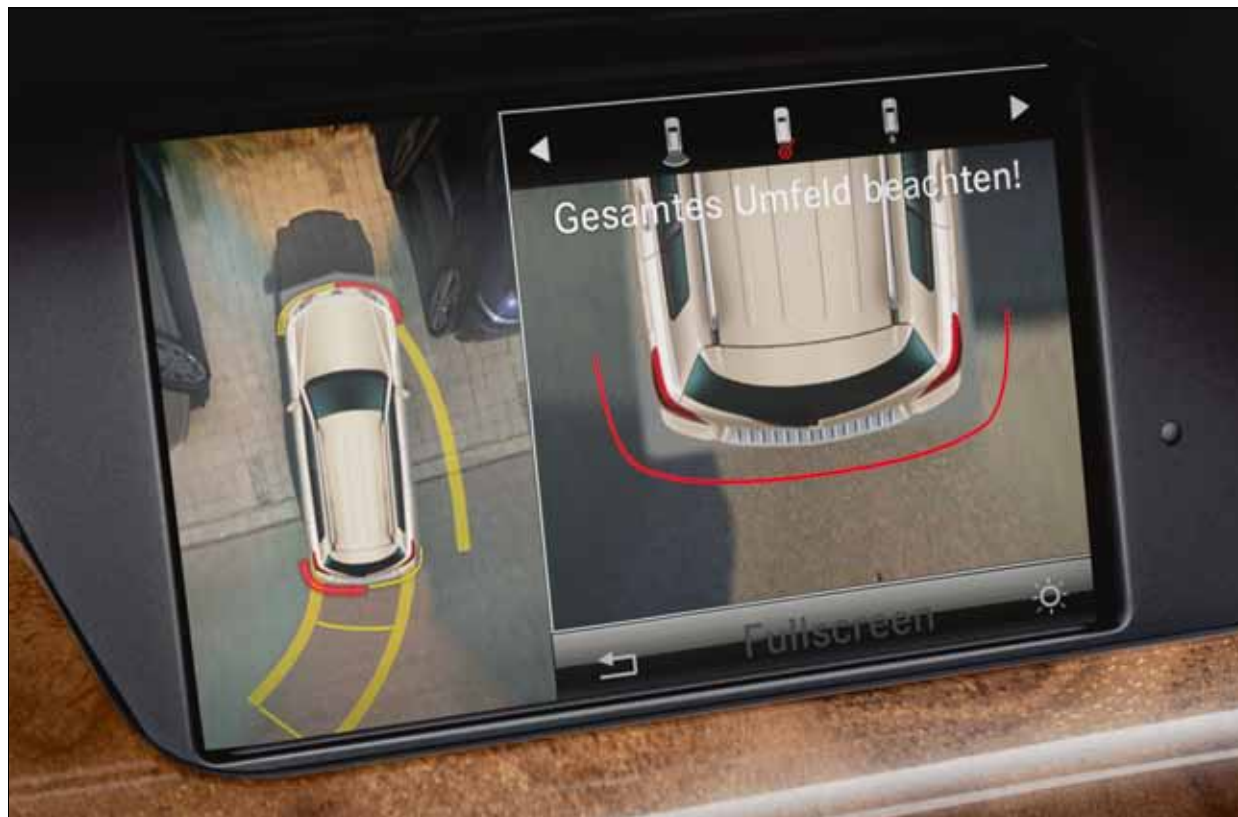
Die 360°-Kamera bildet eine Vogelperspektive des Fahrzeugs in seiner Umgebung ab.
