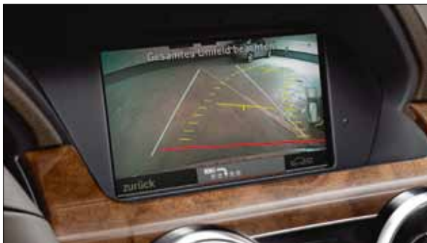
Das Display des COMAND Online zeigt den Bereich hinter dem Fahrzeug während des Einparkvorgangs mit der Rückfahrkamera.
