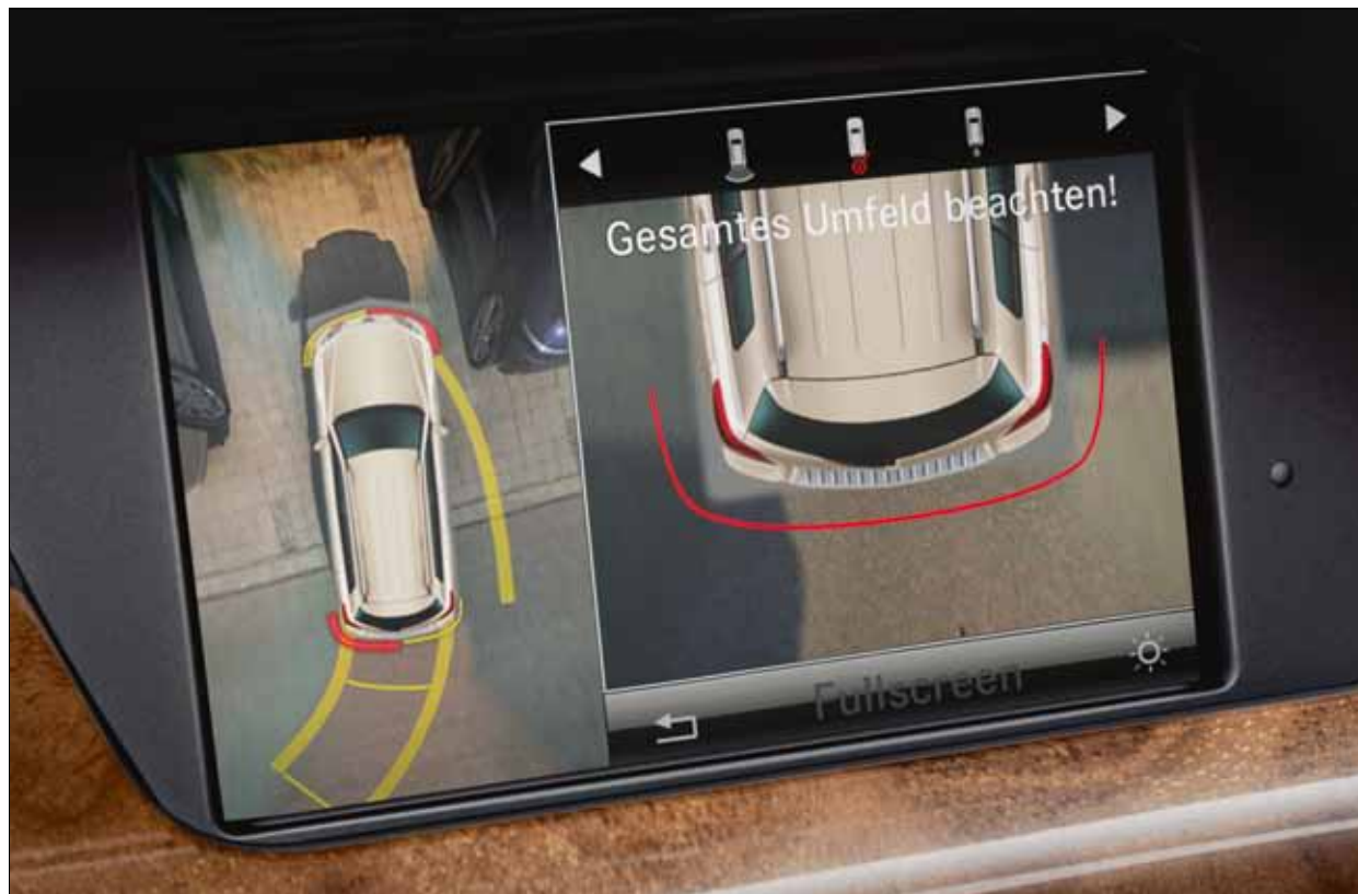
La cámara de 360° ofrece una perspectiva a vista de pájaro del vehículo y su entorno.
