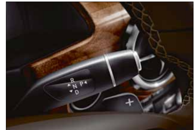
Manejo del cambio con la palanca selectora DIRECT SELECT en el volante. Las levas de cambio permiten cambiar de marcha a mano.
