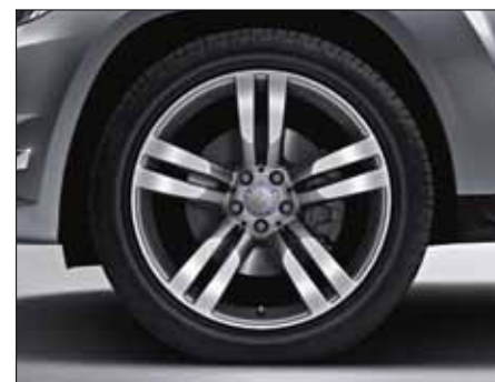
Llanta de aleación de 5 radios dobles gris titanio pulida a alto brillo, con neumáticos 235/45 R 20 delante y 255/40 R 20 detrás (opcional, código 16R).
