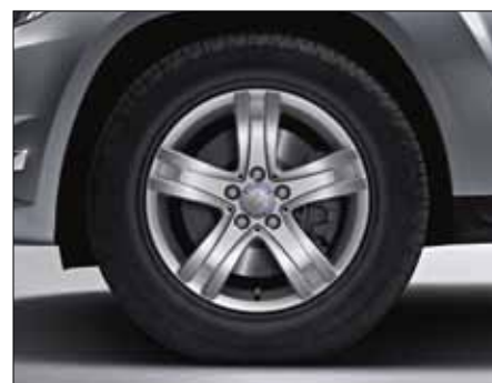
Llanta de aleación de 5 radios en color plata titanio, con neumáticos 235/60 R 17 delante y 255/55 R 17 detrás (accesorio genuino). 1
