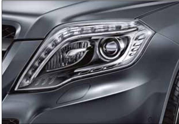
Faros bixenón con Intelligent Light System.
