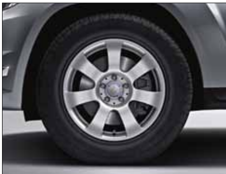
Llanta de aleación de 7 radios con neumáticos 235/60 R 17 (de serie para todos los modelos con motor diésel de 4 cilindros, código 603).
