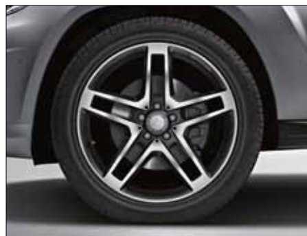
Llanta de aleación AMG de 5 radios dobles negro brillante y pulida a alto brillo, con neumáticos 235/45 R 20 delante y 255/40 R 20 detrás (opcional con el paquete deportivo exterior AMG, código 769).
