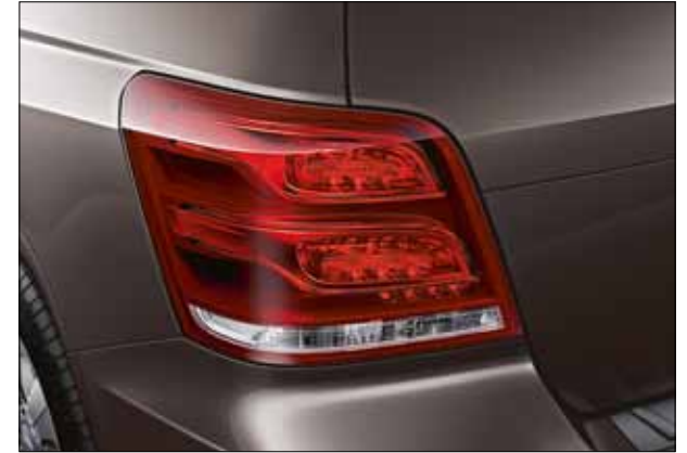
Grupo óptico trasero de LED y fibra óptica.
