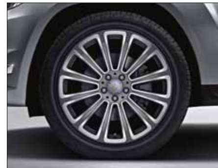
Llanta de aleación multirradio gris titanio con neumáticos 235/45 R 20 delante y 255/40 R 20 detrás (opcional, código 17R).
