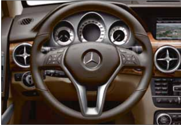
Volante multifunción de confort con 12 teclas y visualizador en color de 11,4 cm en el cuadro de instrumentos.
