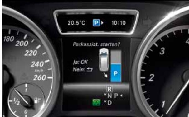
Der automatische Einparkvorgang wird vom System nach maximal fünf Zügen abgeschlossen.
