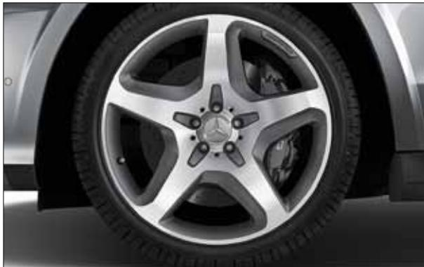
AMG Leichtmetallrad im 5-Speichen-Design mit Bereifung 295/40 R 21, titangrau lackiert und glanzgedreht (Serie für GL 63 AMG, Code 777).
