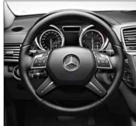
Multifunktionslenkrad in Leder Nappa mit zwölf Funktionstasten sowie Lenkradschaltläpples.
