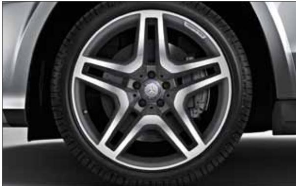
AMG Leichtmetallrad im 5-Doppelspeichen-Design mit Bereifung 295/40 R 21, glanzgedreht (Serie für AMG Sport-Paket Exterieur, Code 757).
