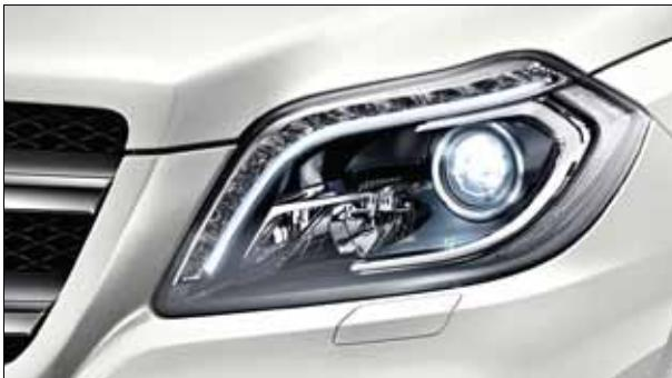
Der Adaptive Fernlicht-Assistent stellt automatisch die jeweils größtmögliche Leuchtwidte zur Verfügung und verbessert so die Sicht des Fahrers.
