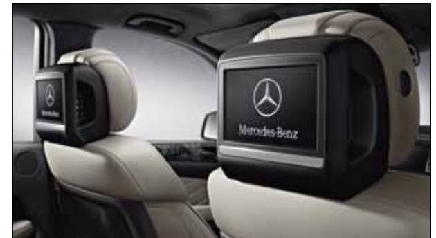
Las pantallas del sistema de entretenimiento para las plazas traseras están sujetas a los reposacabezas delanteros.
