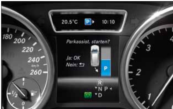
El sistema aparca el vehículo automáticamente mediante un máximo de cinco maniobras.
