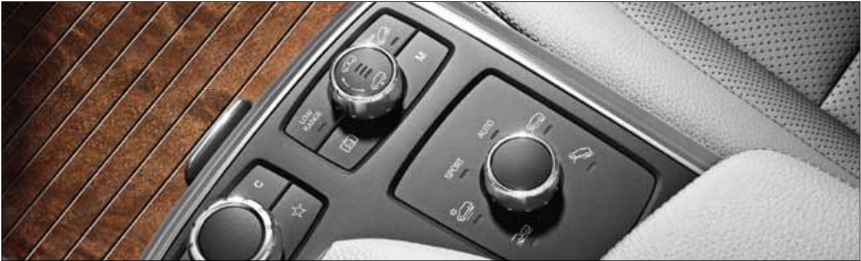
Un botón giratorio en la consola central permite ajustar el programa de conducción.
