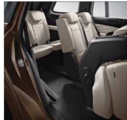
Sistema de acceso de confort EASY-ENTRY manual, a derecha e izquierda en la tercera fila de asientos.
