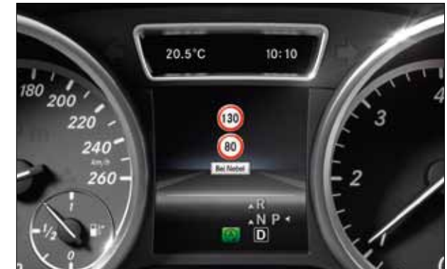
El indicador de velocidad límite puede mostrar limitaciones temporales de la velocidad en el cuadro de instrumentos.
