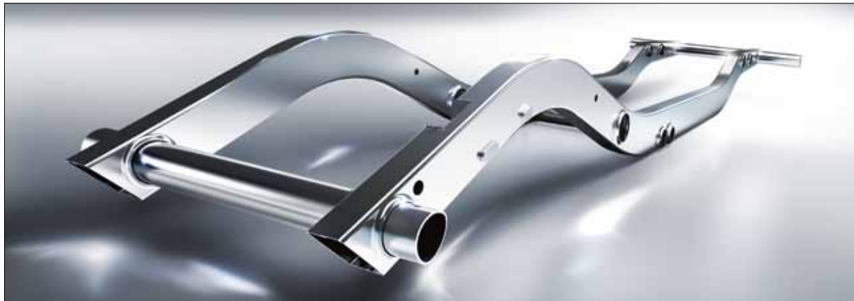
El bastidor de travesaños hace que la Clase G sea extraordinariamente robusta y duradera.
