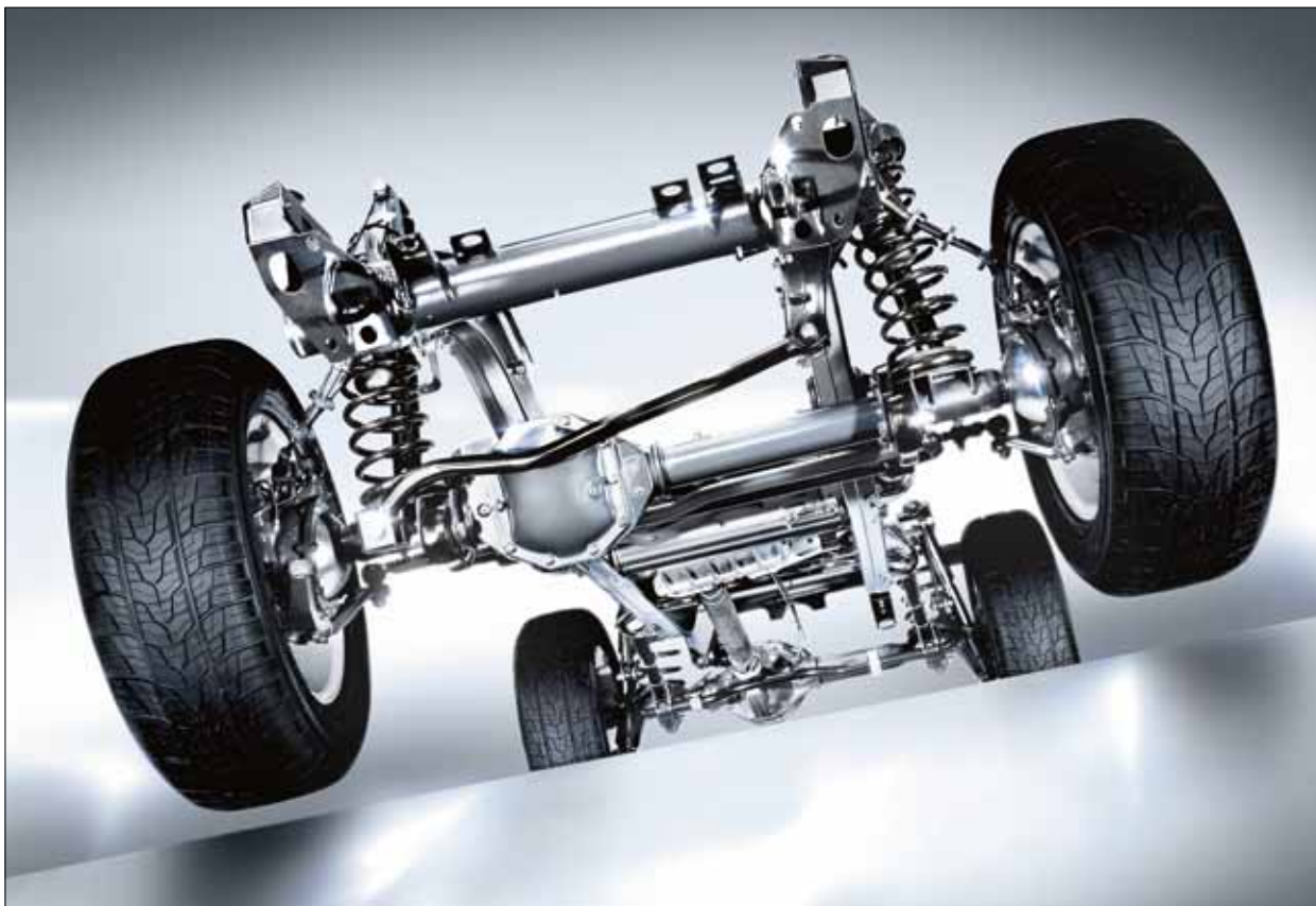
Los ejes rígidos brindan máxima resistencia bajo cargas elevadas fuera del asfalto, así como una altura libre constante sobre el suelo y una tracción ideal.
