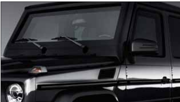
El uso de vidrio especial en varias capas evita la penetración de metralla e inhibe la penetración de proyectiles.
