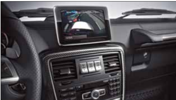
La cámara de marcha atrás muestra al aparcarse una imagen de la zona situada detrás del vehículo.
