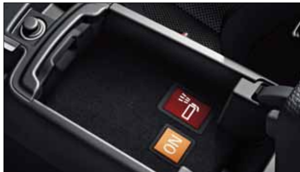
El equipo de extinción de incendios con activación manual y automática asegura que las llamas no puedan extenderse en el habitáculo.
