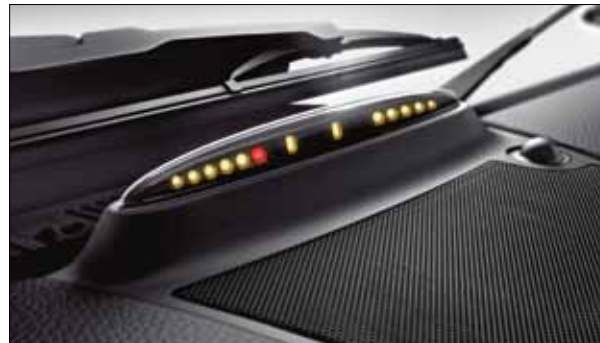
Los diodos luminosos de la ayuda para aparcarse PARKTRONIC indican la separación respecto al obstáculo.
