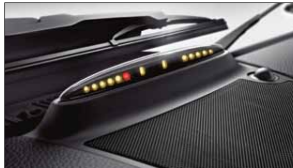
Die Leuchtdioden der PARKTRONIC signalisieren den Abstand zum Hindernis.
