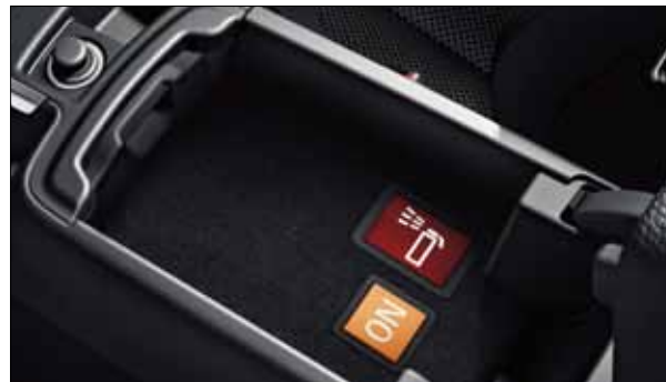
Die Feuerlöschanlage mit manueller und automatischer Auslösetechnik sorgt dafür, dass der Innenraum kein Feuer fängt.
