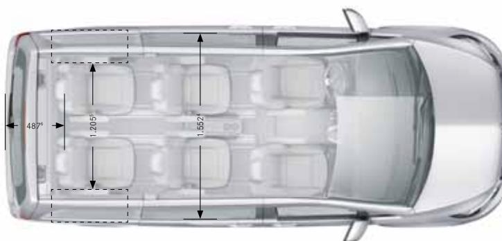
Alle Angaben in mm. Die genannten Maße sind Mittelwerte. Sie gelten für Fahrzeuge in Grundausstattung und in unbelastetem Zustand. <sup>1</sup> Fahrzeughöhe i.V.m. Sonderausstattung Dachreling zusätzlich 48 mm.
