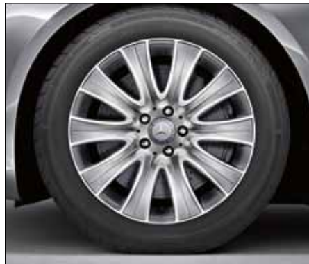
Llanta de aleación de 10 radios, color plata vanadio, con neumáticos 245/50 R 18 (código R41, opcional sin sobreprecio).
