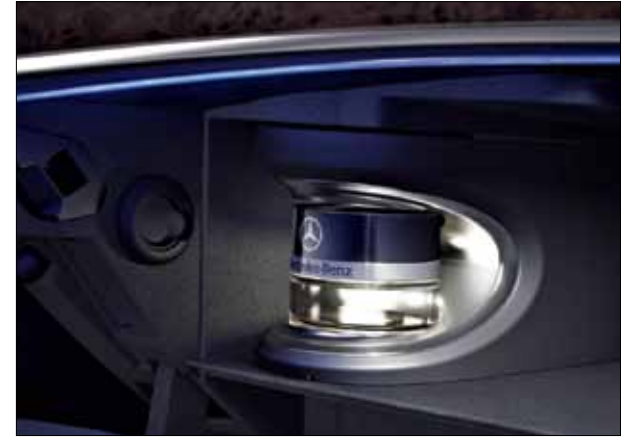
Paquete AIR-BALANCE, incluyendo ionización, filtrado de aire y ambientador.
