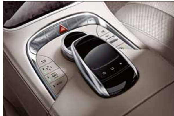
El panel táctil permite controlar cómodamente las funciones de telemática con movimientos de uno o dos dedos.
