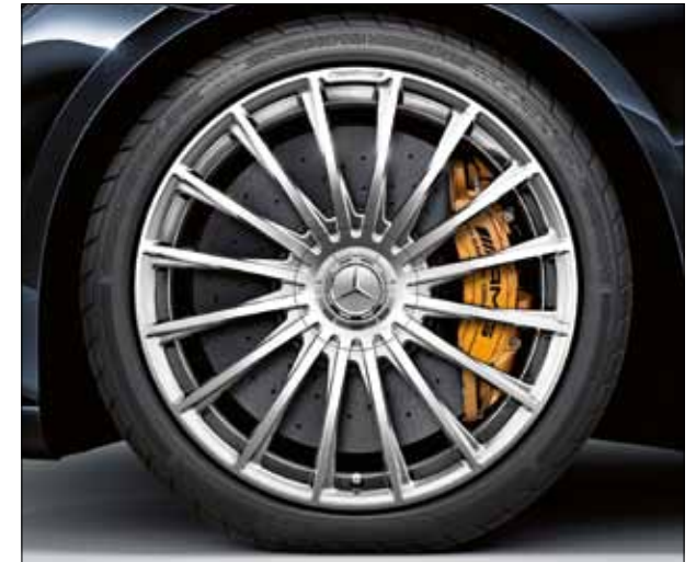
Llanta forjada AMG de 20 pulgadas multirradio de serie con el equipo opcional frenos cerámicos AMG de altas prestaciones con discos de material compuesto.
