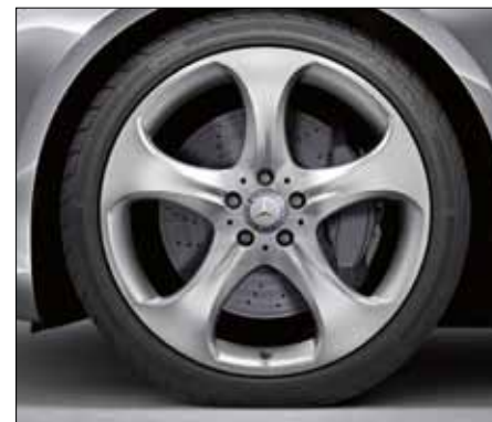
Llanta de aleación de 5 radios, color plata tulio, con neumáticos 245/40 R 20 delante y 275/35 R 20 detrás (accesorio de fábrica, código 53R).
