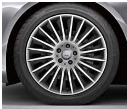
Llanta de aleación en diseño multirradio, color plata vanadio, con neumáticos 245/45 R 19 delante y 275/40 R 19 detrás (código 11R, de serie para S 600).
