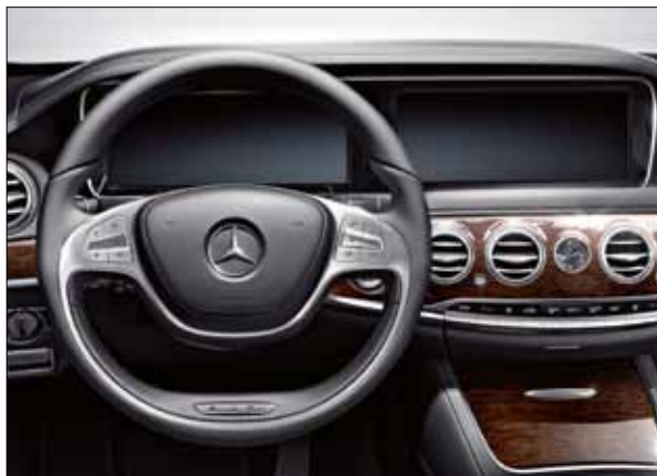
Volante multifunción de dos radios forrado en napa, con doce teclas.
