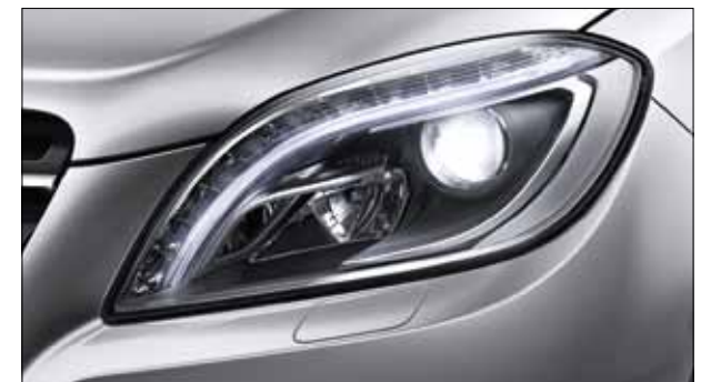
Der Adaptive Fernlicht-Assistent stellt die jeweils größtmögliche Leuchtweite automatisch zur Verfügung und verbessert so die Sicht des Fahrers.
