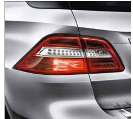
Heckleuchte in LED-Lichtleitertechnik.
