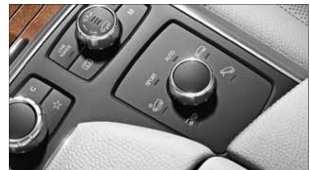
Mit einem Drehschalter auf der Mittelkonsole wird das aktuelle Fahrprogramm eingestellt.
