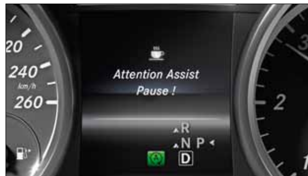
Bei erkannten Anzeichen von zunehmender Müdigkeit beim Fahrer empfiehlt der ATTENTION ASSIST eine Pause.
