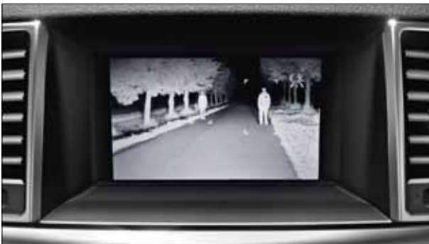
Für eine bessere Erkennbarkeit verfügt der Nachtsicht-Assistent Plus über eine spezielle Fußgängermarkierung im Display.
