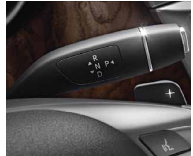
Getriebebedienung mit dem DIRECT SELECT Wählhebel am Lenkrad. Über die Schaltwippen am Lenkrad kann der Fahrer die Schaltvorgänge beeinflussen.
