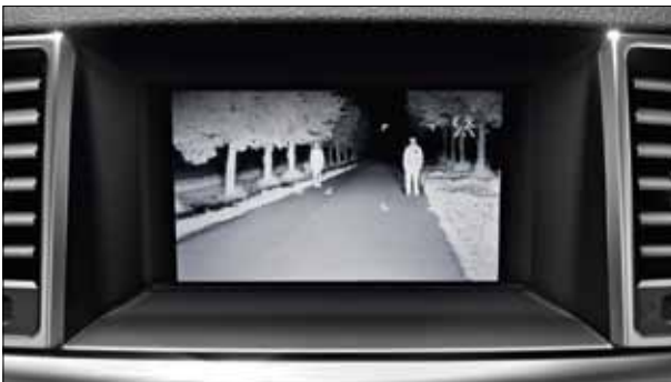
El asistente para visión nocturna Plus marca en la pantalla las personas detectadas y facilita así la identificación de peatones.
