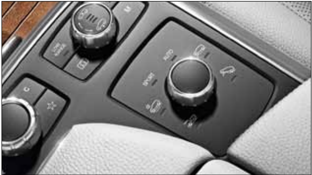
Un interruptor giratorio en la consola central permite ajustar el programa de conducción.
