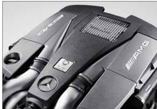
La cubierta del motor de fibra de carbono AMG.
