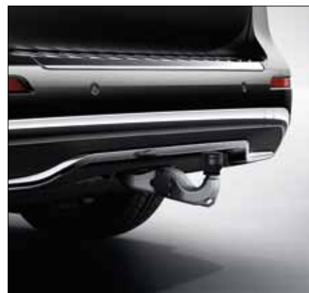
Enganche para remolque con mando eléctrico parcial.
