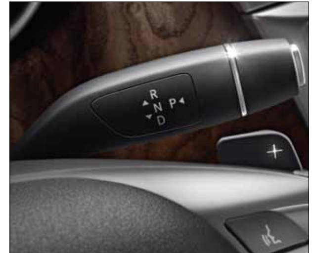
Manejo del cambio con la palanca selectora DIRECT SELECT en el volante. Las levas de cambio permiten al conductor cambiar de marcha manualmente.
