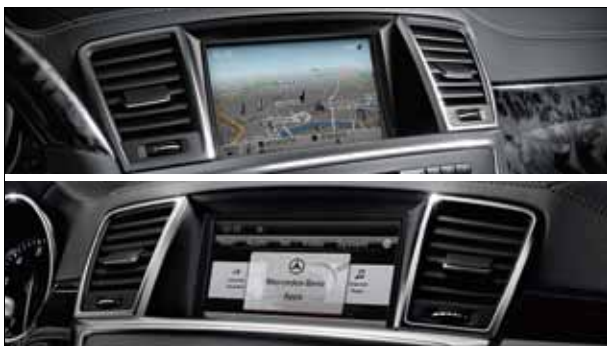
SPLITVIEW visualiza simultáneamente contenidos distintos para el conductor y el acompañante.
