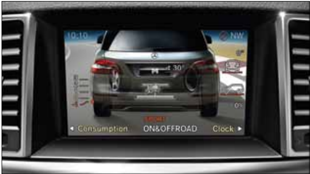
En el display del COMAND se indica el programa de conducción y se muestran la pendiente y el ángulo de inclinación.
