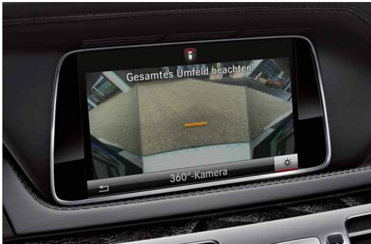
La cámara de 360° utiliza cuatro cámaras y puede visualizar distintas perspectivas del vehículo y de su entorno.
