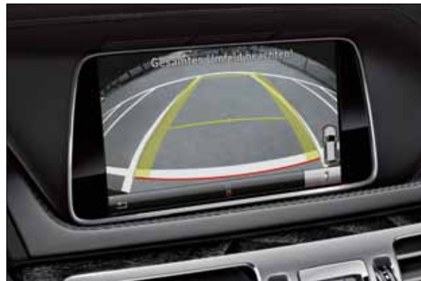
Al aparcar, el display central de COMAND Online muestra el entorno por detrás del vehículo.
