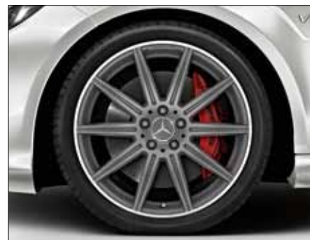
Llanta de aleación AMG de 10 radios, color gris titanio mate y pestaña de llanta pulida a alto brillo, neumáticos 255/35 R 19 delante y 285/30 R 19 detrás (de serie sólo para Mercedes-AMG E 63 S 4MATIC, código 662).
