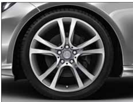
Llanta de aleación de 5 radios dobles con neumáticos 245/35 R 19 delante y 275/30 R 19 detrás (opcional, código R17).
