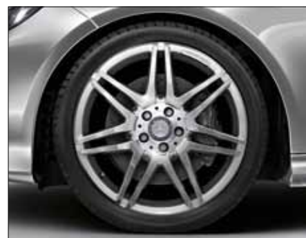
Llanta de aleación AMG de 7 radios dobles con neumáticos 245/35 R 19 delante y 275/30 R 19 detrás (opcional, código 770).
