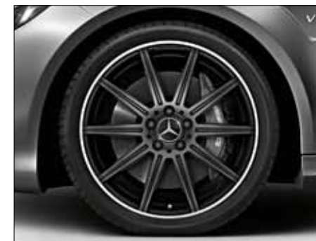
Llanta de aleación AMG de 10 radios con neumáticos 255/35 R 19 delante y 285/30 R 19 detrás, color negro mate con pestaña pulida a alto brillo (opcional para modelos AMG, código 752).
