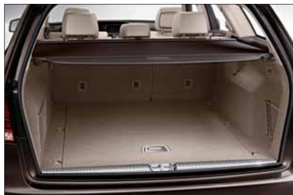
El estor cubreequipajes automático EASY-PACK se desplaza hacia arriba al abrir el portón.
