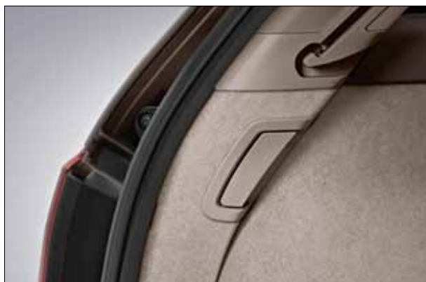
Palanca de desbloqueo para abatir fácilmente los respaldos traseros.
