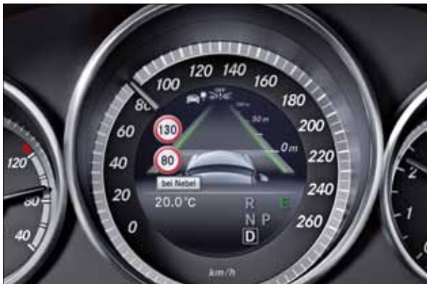
El asistente para señales de tráfico muestra limitaciones de velocidad, prohibiciones de adelantamiento o señales de dirección prohibida.
