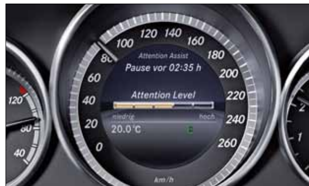
Si se detectan síntomas de aumento de la fatiga en el conductor, el sistema ATTENTION ASSIST recomienda hacer un descanso.
