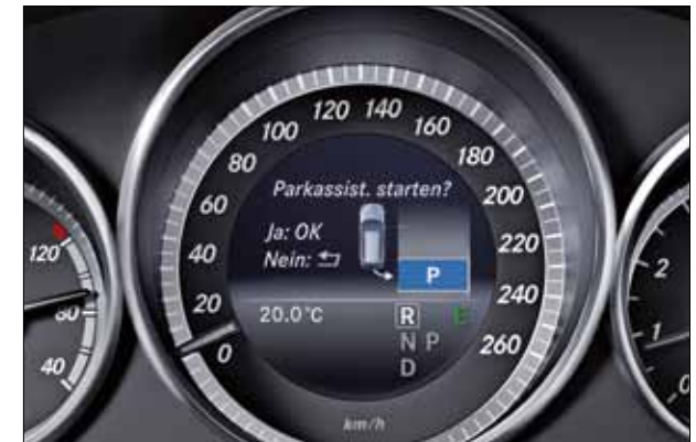
El display situado en el cuadro de instrumentos muestra la información más importante sobre la maniobra de aparcamiento.
