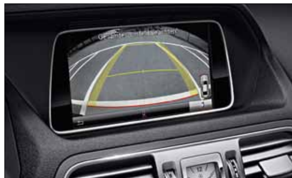
Die Rückfahrkamera unterstützt mit statischen und dynamischen Hilfslinien bei Rückfahrvorgängen.
