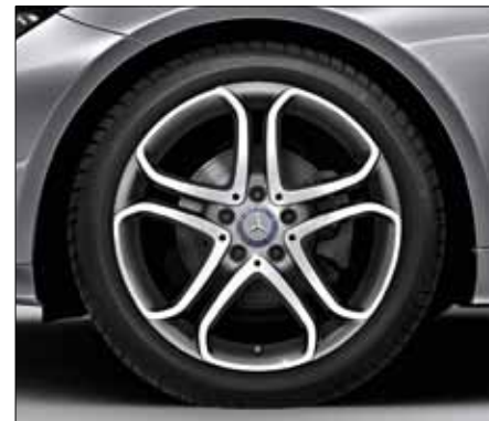
Leichtmetallrad im 5-Doppelspeichen-Design mit Bereifung vorne 235/40 R 18 und hinten 255/35 R 18 (optional, Code R71, Serie für 8-Zylinder, Bestandteil des Sport-Pakets Exterieur).
