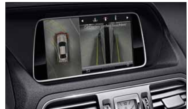
Das zentrale Display des COMAND Online zeigt den Bereich um das Fahrzeug während des Einparkvorgangs.
