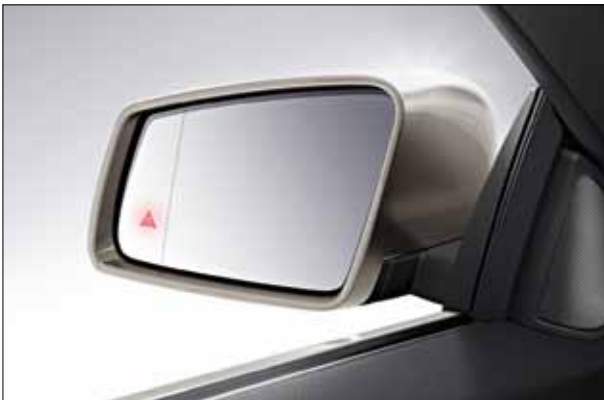
Der Spurhalte-Assistent und der Totwinkel-Assistent können den Fahrer in potenziell gefährlichen Fahrsituationen, z. B. beim Spurwechsel, warnen.
