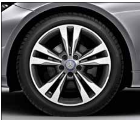
Leichtmetallrad im 5-Doppelspeichen-Design mit Bereifung vorne 235/40 R 18 und hinten 255/35 R 18 (optional, Code 22R).
