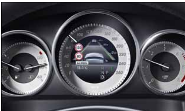
Im Display zeigt der Verkehrszeichen-Assistent dem Fahrer, welche Tempolimits und Verkehrszeichen gerade gelten.
