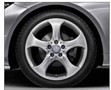
Leichtmetallrad im 5-Speichen-Design mit Bereifung vorne 235/40 R 18 und hinten 255/35 R 18 (optional, Code R08).
