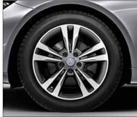
Leichtmetallrad im 5-Doppelspeichen-Design mit Bereifung 235/45 R 17 (Serie für 4- und 6-Zylinder, Code 44R).
