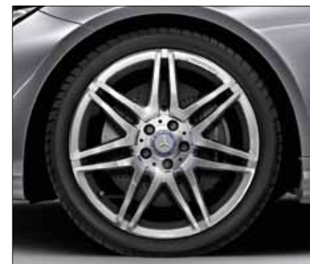
AMG Leichtmetallrad im 7-Doppelspeichen-Design, glanzgedreht, mit Bereifung vorne 235/35 R 19 und hinten 255/30 R 19 (optional, Code 770).
