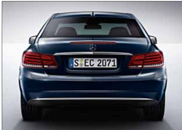
Bei der serienmäßigen Abgasanlage sind die Endrohrblenden vom Stoßfänger verdeckt.
