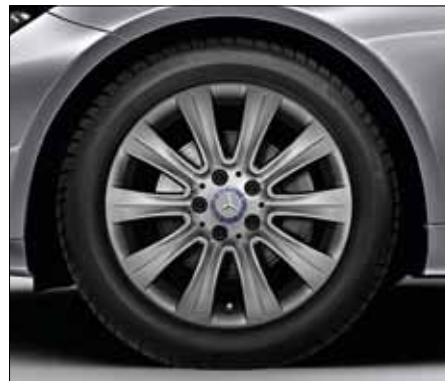
Leichtmetallrad im 10-Speichen-Design mit Bereifung 235/45 R 17 (optional für 4- und 6-Zylinder, Code 25R).
