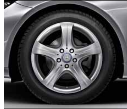
Leichtmetallrad im 5-Speichen-Design mit Bereifung vorne 235/45 R 17 und hinten 255/40 R 17 (optional für 4- und 6-Zylinder, Code R22).
