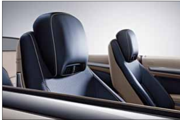
Die Kopfraumheizung AIRSCARF wirkt wie ein Schal.
