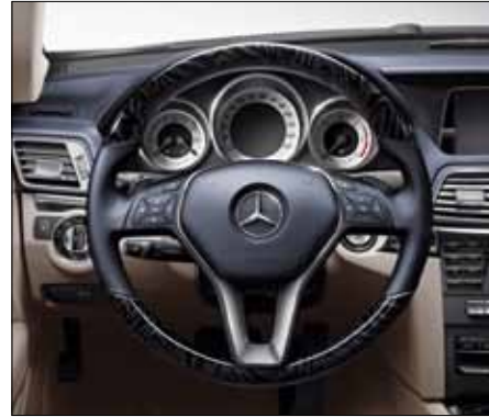
Multifunktionslenkrad in Holz-Leder-Ausführung mit Lenkradschalt paddles.
