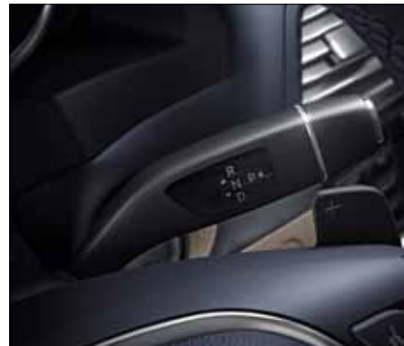
DIRECT SELECT Wählhebel und Lenkradschalt paddles.
