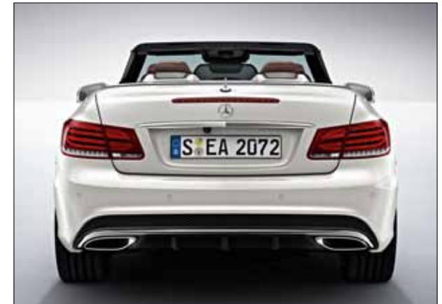
Das Sport-Paket AMG bietet eine zweiflutige Abgasanlage mit stoßfängerfesten trapezförmigen Endrohrblenden in poliertem Edelstahl.
