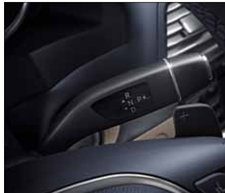
Palanca selectora DIRECT SELECT y levas de cambio en el volante.
