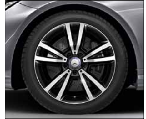
Llanta de aleación de 5 radios dobles, color negro brillante y pulida a alto brillo, con neumáticos 235/40 R 18 delante y 255/35 R 18 detrás (código 83R, forma parte del paquete Night para E 500).
