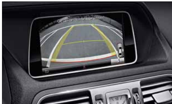
La cámara de marcha atrás facilita las maniobras marcha atrás con líneas auxiliares fijas y dinámicas en la pantalla.
