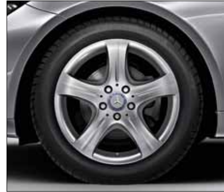
Llanta de aleación de 5 radios con neumáticos 235/45 R 17 delante y 255/40 R 17 detrás (código R22, opcional para modelos de 4 y 6 cilindros, de serie para E 350 4MATIC).
