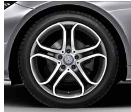
Llanta de aleación de 5 radios dobles con neumáticos 235/40 R 18 delante y 255/35 R 18 detrás (código R71, opcional, de serie para modelos de 8 cilindros).
