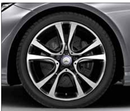
Llanta de aleación de 5 radios dobles, color negro brillante y pulidas a alto brillo, neumáticos 235/35 R 19 delante y 255/30 R 19 detrás (código R90, opcional en combinación con paquete Night para E 500).
