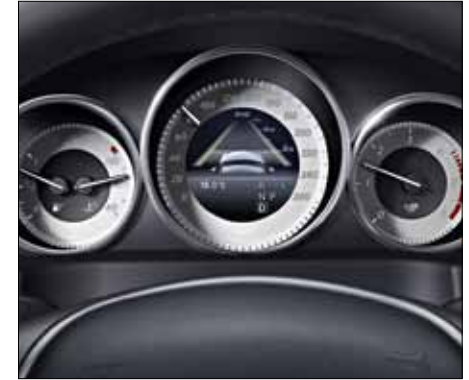
Indicación del COLLISION PREVENTION ASSIST en el cuadro de instrumentos de tres tubos.
