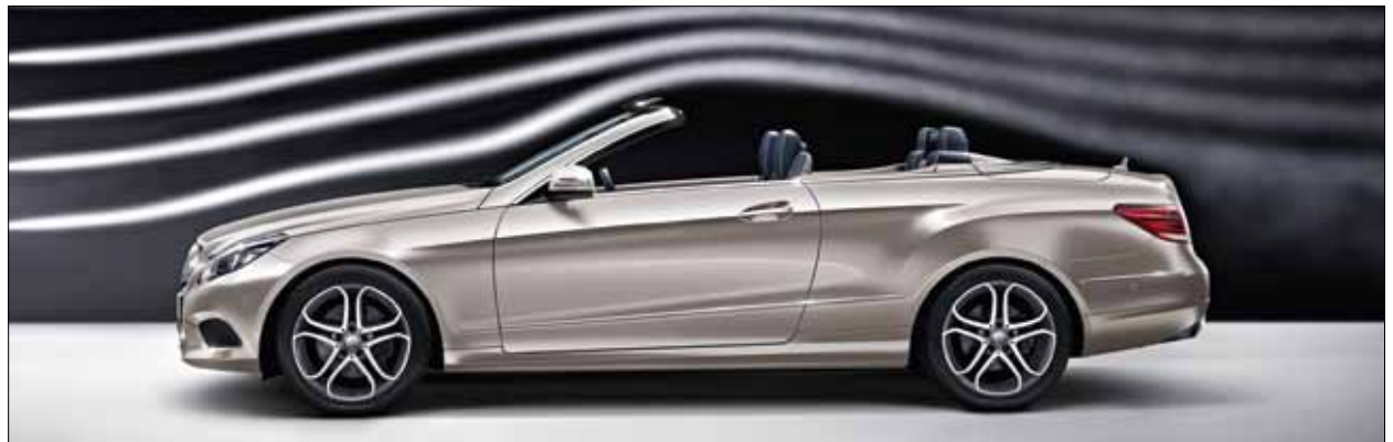
Simplemente genial: AIRCAP desvía la corriente de aire por encima de los cuatro ocupantes del vehículo.
