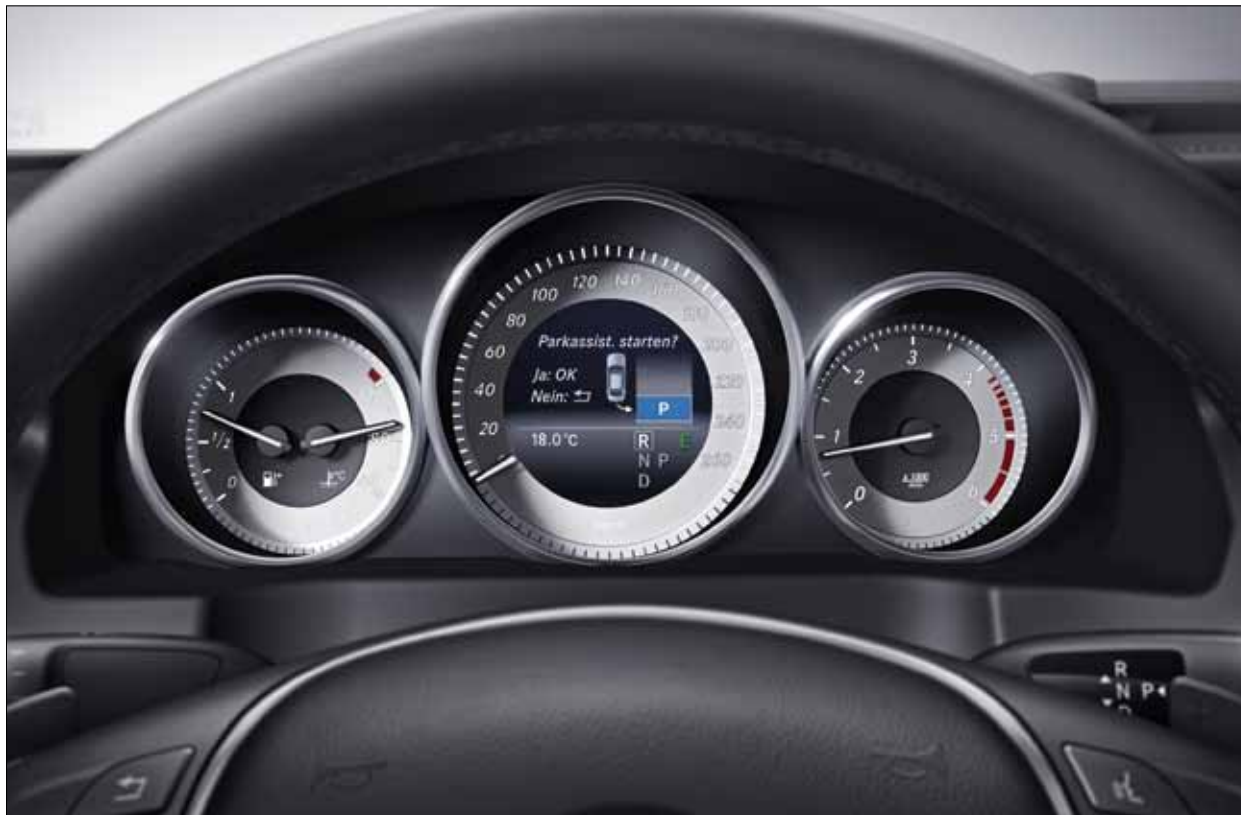
El display situado en el cuadro de instrumentos le muestra la información más importante sobre la maniobra de aparcamiento.
