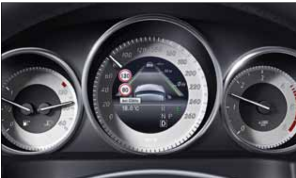
El asistente de señales de tráfico visualiza en el display el límite de velocidad y las prohibiciones que rigen en el momento.
