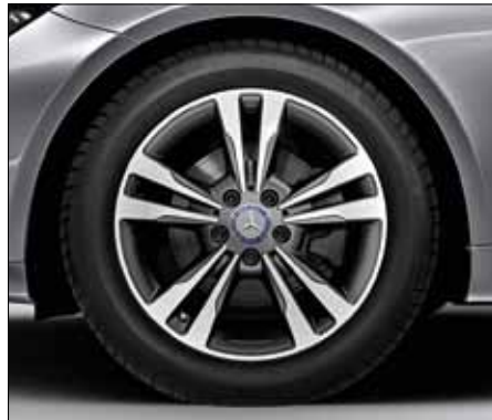
Llanta de aleación de 5 radios dobles con neumáticos 235/45 R 17 (código 44R, de serie para modelos de 4 y 6 cilindros excepto E 350 4MATIC).
