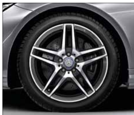
Llanta de aleación AMG de 5 radios dobles, color gris titanio y pulida a alto brillo, con neumáticos 235/40 R 18 delante y 255/35 R 18 detrás (código 660, forma parte del paquete deportivo AMG).
