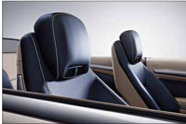
La calefacción integrada en los reposacabezas AIRSCARF actúa como una bufanda de aire caliente.
