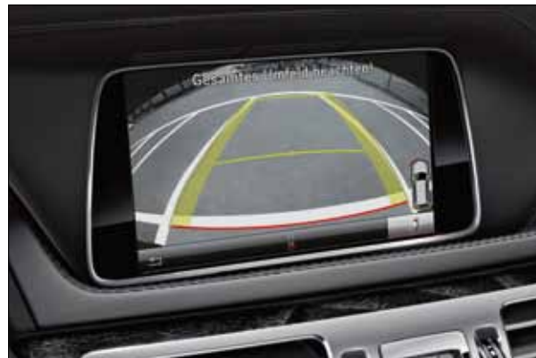
Das zentrale Display des COMAND Online zeigt den Bereich hinter dem Fahrzeug während des Einparkvorgangs.
