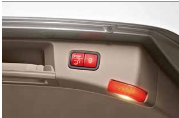
Die EASY-PACK Heckklappe kann per Knopfdruck auch in einer niedrigeren Stellung öffnen und schließen.
