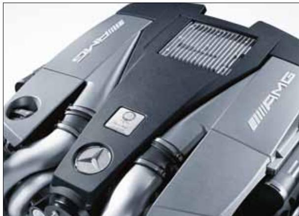
Erprobte Technik: der AMG 5,5-Liter-V8-Motor mit Biturboaufladung.
