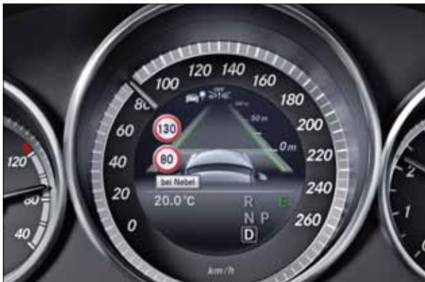
Der Verkehrszeichen-Assistent zeigt neben Geschwindigkeitsbeschränkungen auch Überholverbote oder das falsche Einfahren auf eine Autobahnauffahrt an.
