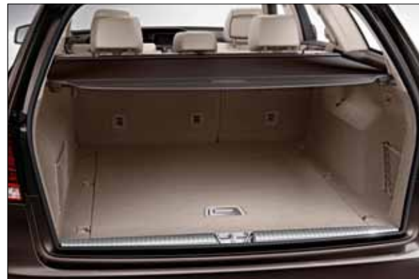
Die EASY-PACK Laderaumabdeckung bewegt sich beim Öffnen der Heckklappe mit nach oben.
