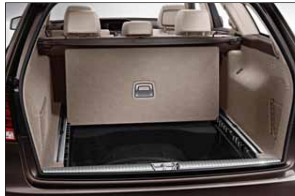
Der EASY-PACK Faltladeboden erlaubt eine stufenweise Öffnung.
