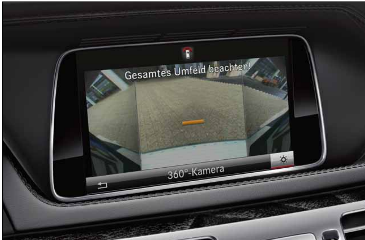
Die 360°-Kamera kann mithilfe von vier Kameras Ansichten rund um das Fahrzeug darstellen.
