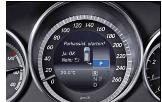
Das Display im Kombiinstrument gibt jederzeit einen Überblick über den aktuellen Parkvorgang.
