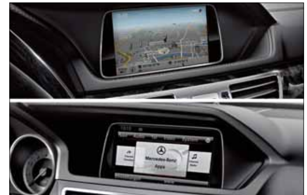
SPLITVIEW zeigt für Fahrer und Beifahrer gleichzeitig unterschiedliche Inhalte auf einem Bildschirm an.
