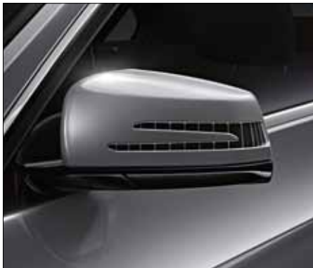
Außenspiegel links und rechts beheizt, von innen elektrisch einstellbar.
