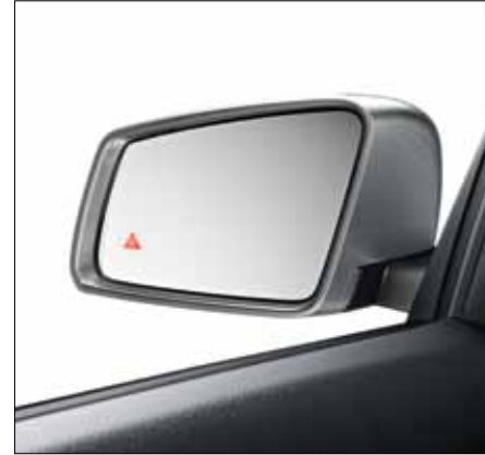
El control activo de ángulo muerto supervisa la zona del «ángulo muerto», pudiendo advertir de un cambio de carril peligroso.
