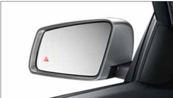
El control de ángulo muerto puede advertir de un posible peligro mediante una señal acústica y un triángulo rojo en el retrovisor exterior.
