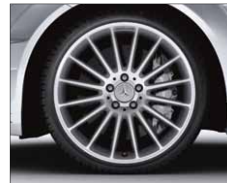
Llanta de aleación AMG multirradio, color gris titanio y pulida a alto brillo, con neumáticos 235/35 R 19 delante y 255/30 R 19 detrás (opcional para C 63 AMG, código 788).
