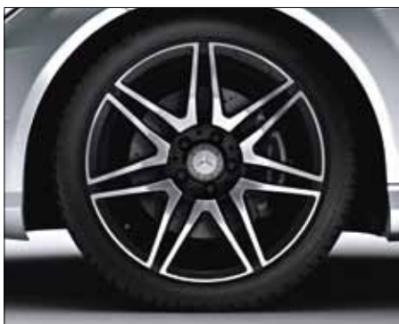
Llanta de aleación AMG de 7 radios dobles con 225/40 R 18 delante y 255/35 R 18 detrás, color negro brillante y pulida a alto brillo (de serie paquete deportivo AMG Plus y modelos Sport (P84), código 760).
