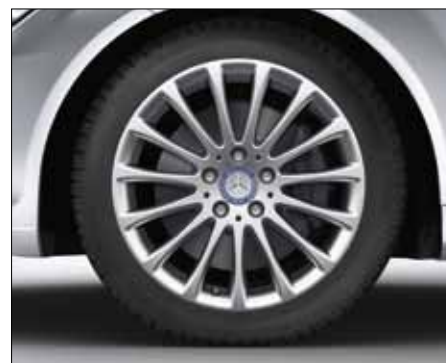
Llanta de aleación multirradio con neumáticos 225/45 R 17 delante y 245/40 R 17 detrás (opcional, código 56R).
