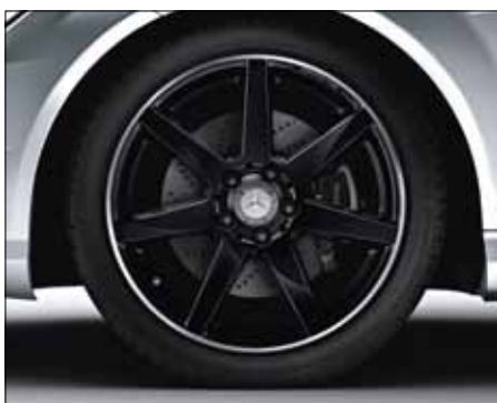
Llanta de aleación AMG de 7 radios con 225/40 R 18 delante y 255/35 R 18 detrás, color negro brillante y con pestaña pulida a alto brillo (opcional para todos los paquetes deportivos y modelos Sport (P84), código 661).
