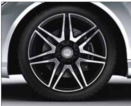
AMG Leichtmetallrad im 7-Doppelspeichen-Design, in Hochglanzschwarz lackiert und glanzgedreht, mit Bereifung 225/40 R 18 vorne und 255/35 R 18 hinten (Serie Sport-Paket AMG Plus und Sport-Modelle, Code 760).
