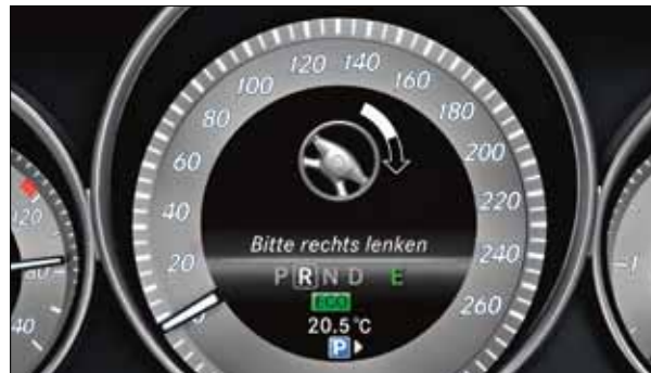
Die Parkführung gibt dem Fahrer Hinweise zum richtigen Lenkwinkel sowie zu den Ein- und Umlenkpunkten.
