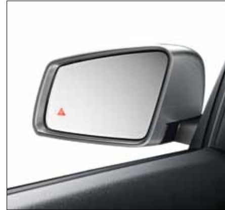
Der Totwinkel-Assistent überwacht den toten Winkel und kann vor gefährlichen Spurwechseln warnen.
