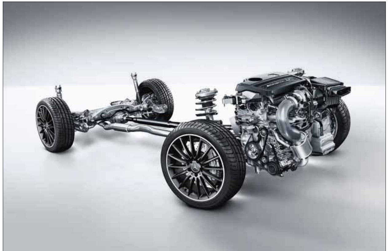
Las manguetas de desarrollo propio del eje delantero, con elastocinemática específica, fomentan el dinamismo gracias a los cojinetes de mayor rigidez.
