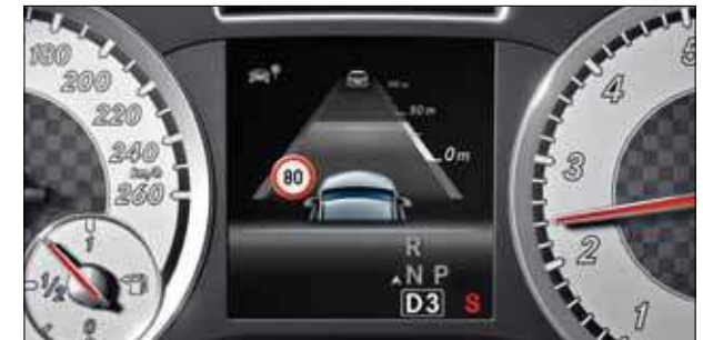
El indicador de velocidad límite informa al conductor en el cuadro de instrumentos y en el display central de COMAND Online.
