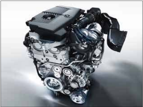
El motor de gasolina de 4 cilindros A 180 trabaja con inyección directa, inyectores piezoeléctricos y sobrealimentación por turbocompresor.
