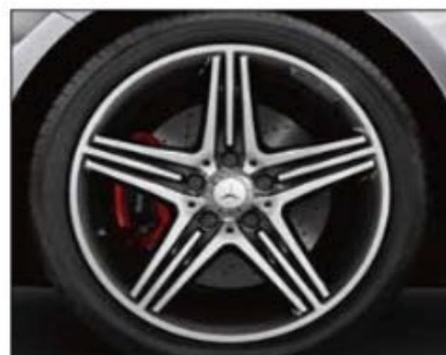
AMG Leichtmetallrad im 5-Speichen-Design, schwarz lackiert, glanzgedreht, mit Bereifung 235/40 R 18 (Serie für A 250 Sport und A 250 Sport 4MATIC, Code 774).
