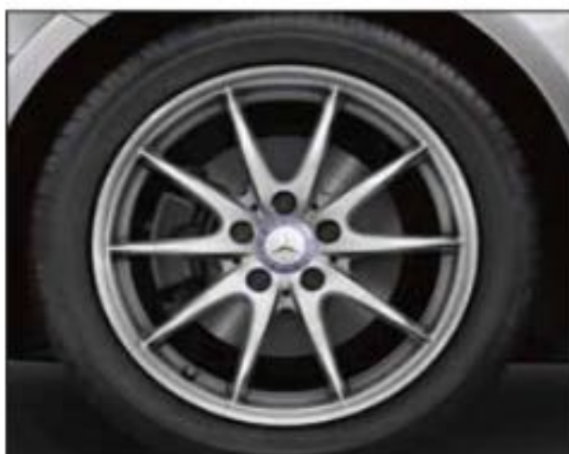
Leichtmetallrad im 10-Speichen-Design mit Bereifung 225/45 R 17 (Serie für A 220 CDI, A 250 und A 250 4MATIC, Code R43).
