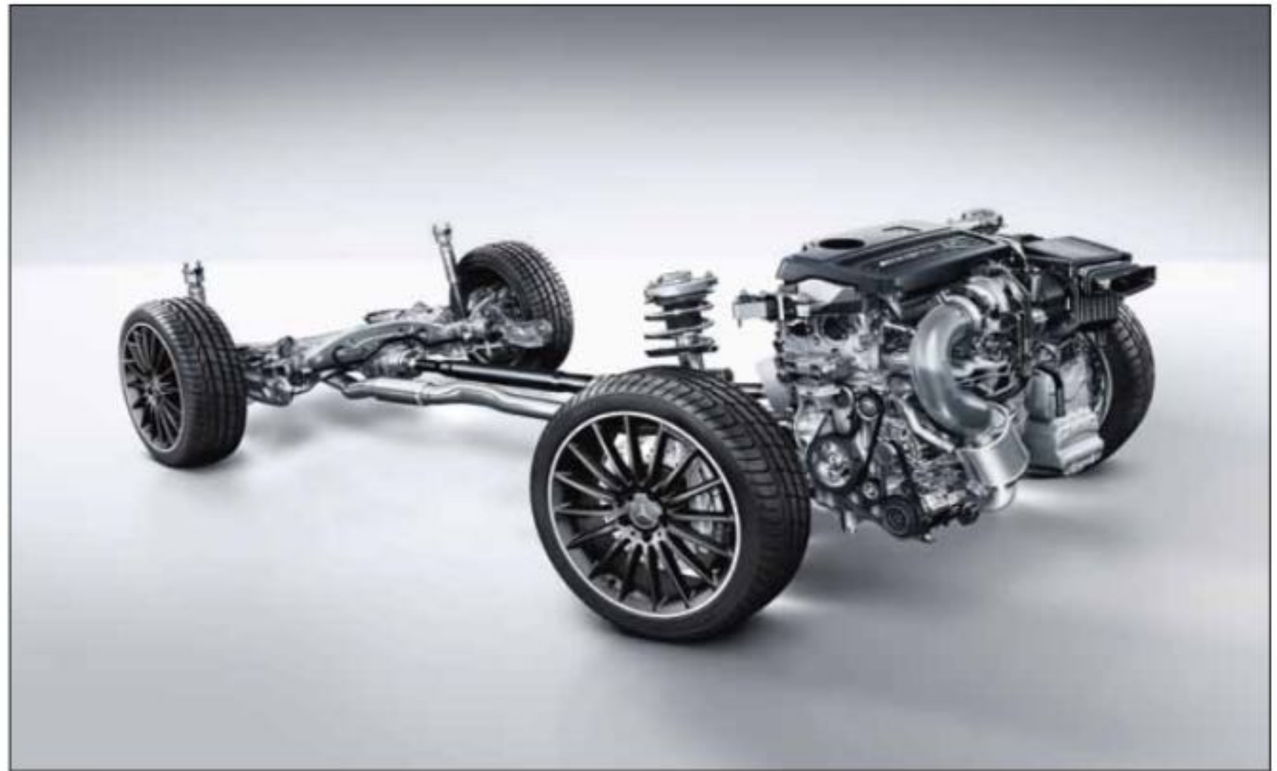
Eigenständige Achsschenkel vorne mit AMG spezifischer Elastokinematik erhöhen durch steifere Achslager die Dynamik.
