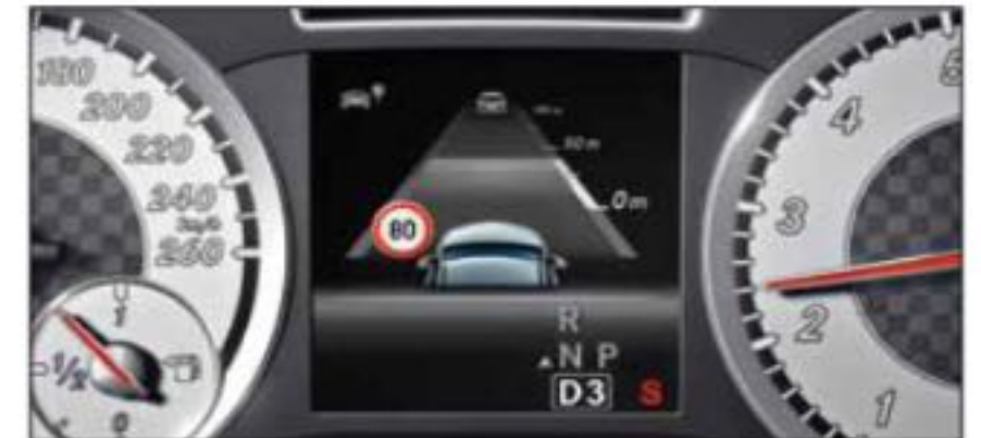
Die Anzeige des Geschwindigkeitslimit-Assistenten erfolgt sowohl im Kombiinstrument als auch im zentralen Display des COMAND Online.
