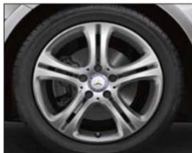
Leichtmetallrad im 5-Doppelspeichen-Design mit Bereifung 225/45 R 17 (Serie in Verbindung mit Urban, Code R11).
