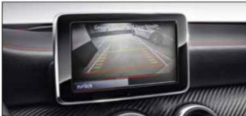
Das zentrale Display des COMAND Online zeigt den Bereich hinter dem Fahrzeug während des Einparkvorgangs.
