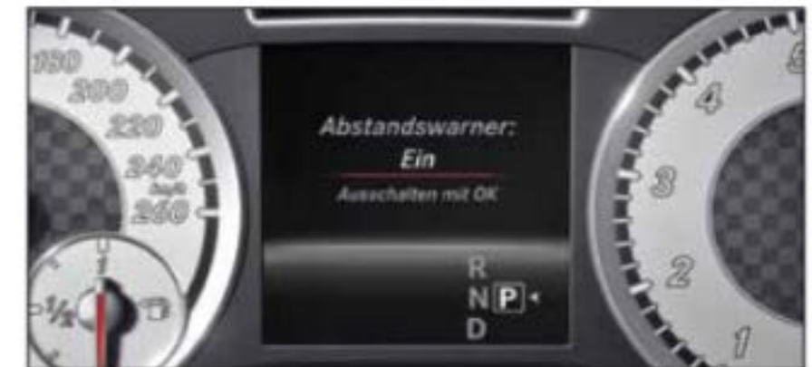
Der COLLISION PREVENTION ASSIST kann einen zu geringen Sicherheitsabstand erkennen und den Fahrer warnen.
