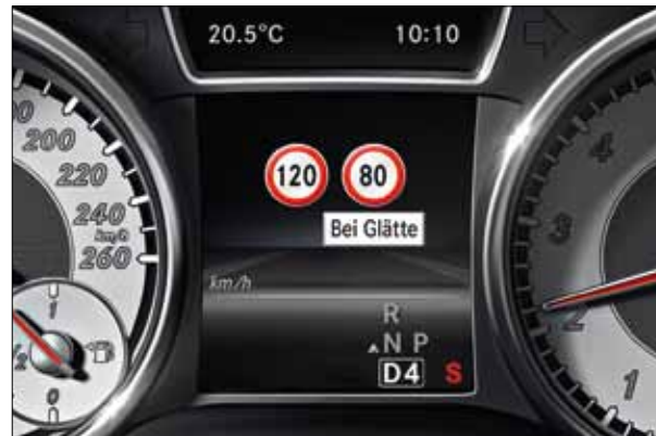
El asistente para señales de tráfico informa al conductor en el cuadro de instrumentos y en el display central de COMAND Online.
