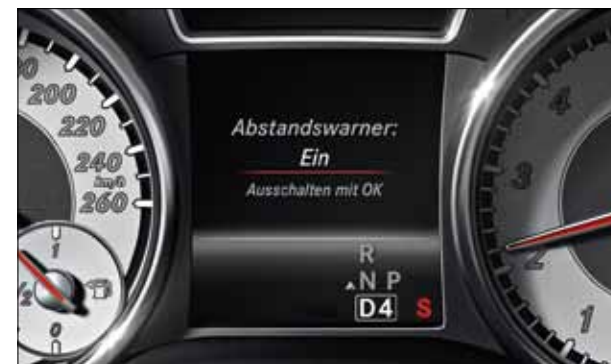
COLLISION PREVENTION ASSIST PLUS puede avisar al conductor con una señal óptica y acústica si la distancia de seguridad se reduce peligrosamente.
