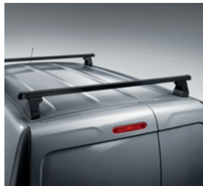
Soporte básico para el techo estándar, dos travesaños 1 . El robusto perfil rectangular constituye la base para diversos soportes específicos. Se atornilla a los puntos de sujeción existentes en el perfil en el techo.
