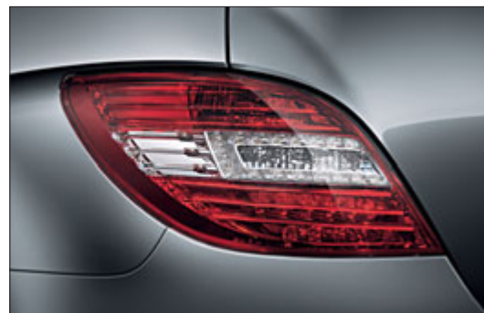
Gruppi ottici posteriori a LED e tecnologia a fibre ottiche
