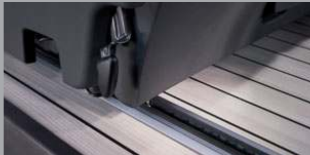
Řady sedadel lze posouvat v rastru 25 mm. Tak můžete přizpůsobovat velikost úložného prostoru.
