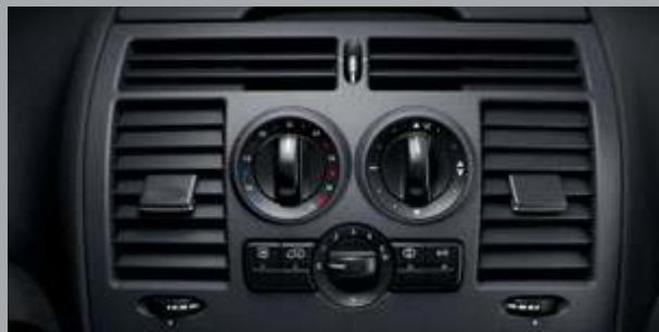
O čerstvý vzduch se za každého počasí stará klimatizace TEMPMATIK s kombinovaným filtrem prachu a aktivního uhlí dodávaná ve standardní výbavě.
