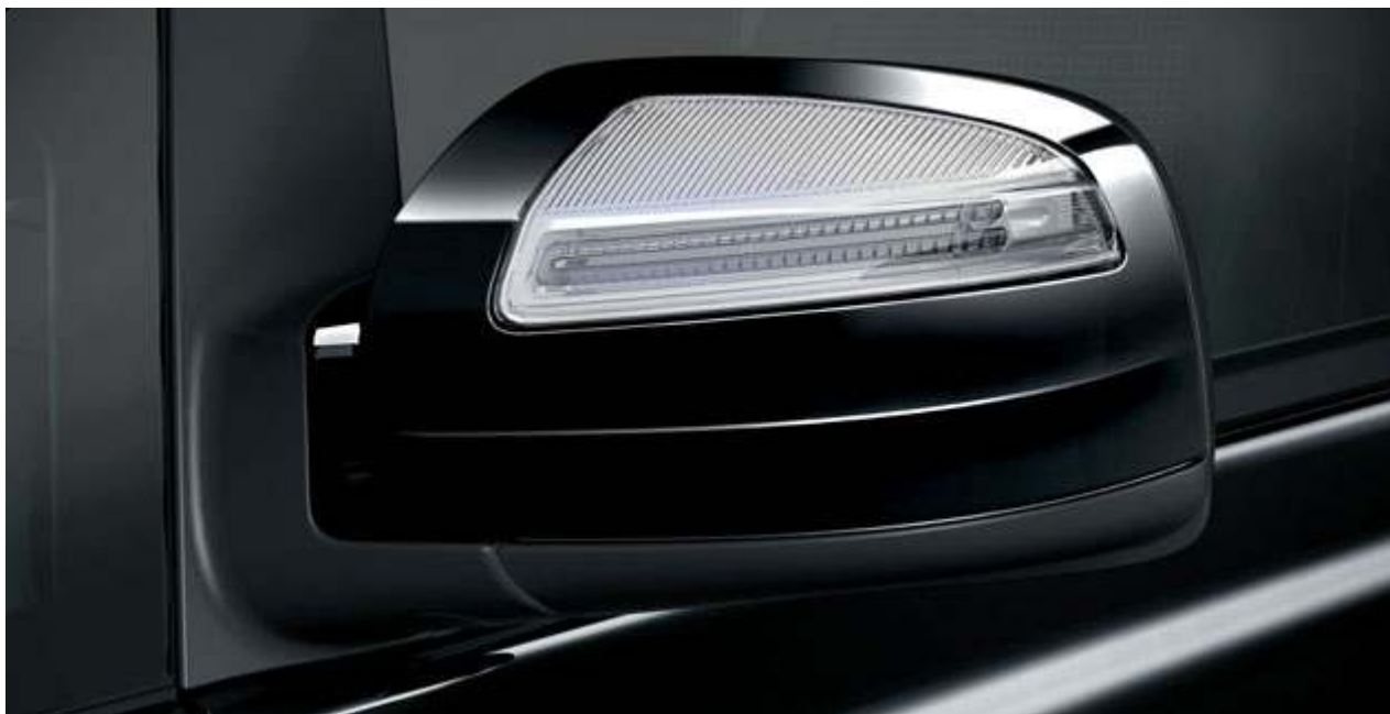
Vnější zpětné zrcátko s větším zorným polem a integrovanými směrovými světly, elektricky nastavitelné.
