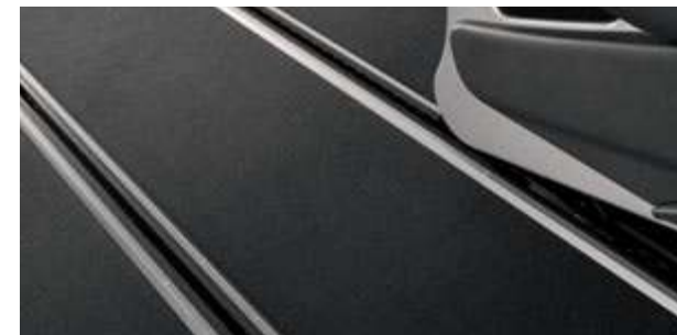
Systém kolejnic pro variabilní uspořádání sedadel.
