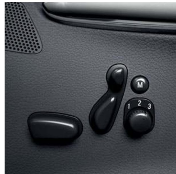
Sedadlo řidiče a spolujezdce elektricky seřiditelné s pamětí pro trojí nastavení sedadel.
