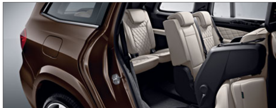
Sistema EASY-ENTRY a ambos lados para facilitar el acceso (opcionalmente con accionamiento eléctrico).
