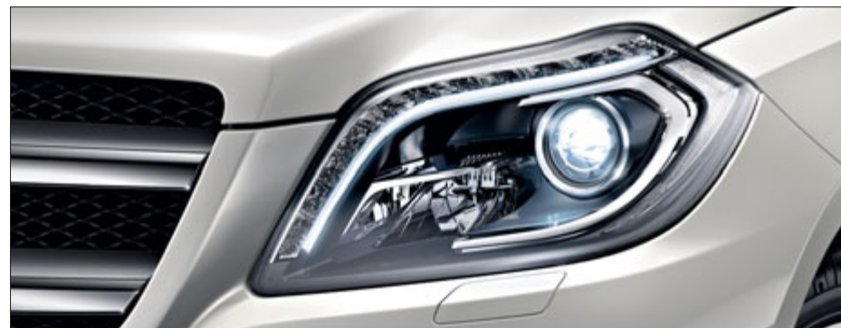
Intelligent Light System con faros bixenón adapta el alumbrado automáticamente a las condiciones de marcha. 1
