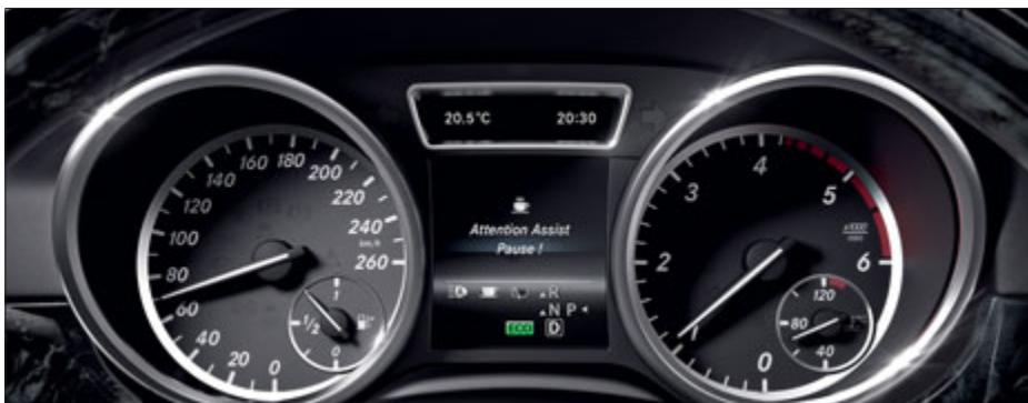
Cuadro de instrumentos en diseño de dos tubos con visualizador en color.
