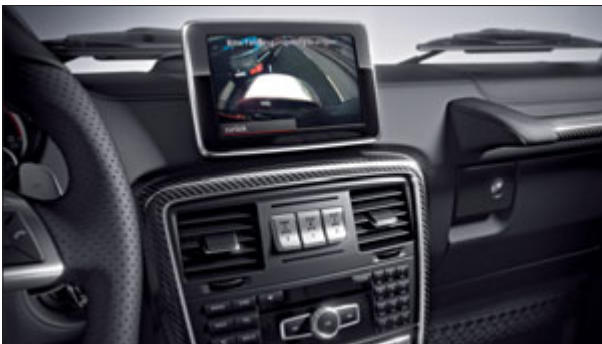
Das zentrale Display des COMAND Online zeigt den Bereich hinter dem Fahrzeug während des Einparkvorgangs.
