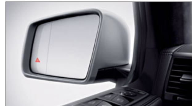
Der Totwinkel-Assistent macht Spurwechsel sicherer.
