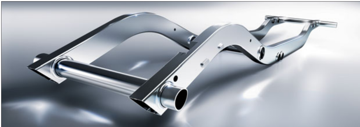
Der Leiterrahmen macht die G-Klasse außerordentlich stabil und langlebig.
