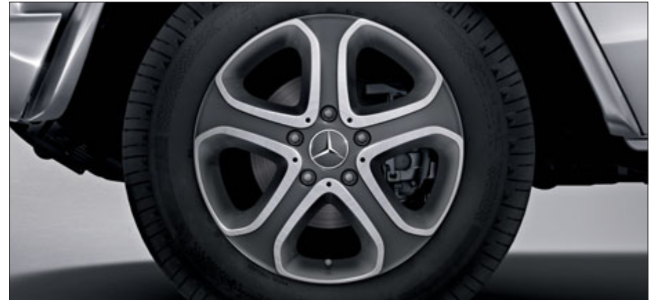
Leichtmetallrad im 5-Speichen-Design mit Bereifung 265/60 R 18, titangrau lackiert und glanzgedreht (Serie für „Final Edition 200“ und Sport-Paket, optional für G 350 BlueTEC, G 500, Code RL5).
