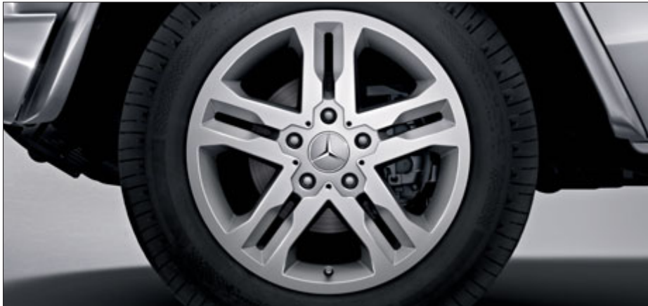
Leichtmetallrad im 5-Doppelspeichen-Design mit Bereifung 265/60 R 18 (Serie für G 500, optional für G 350 BlueTEC, Code RM9).
