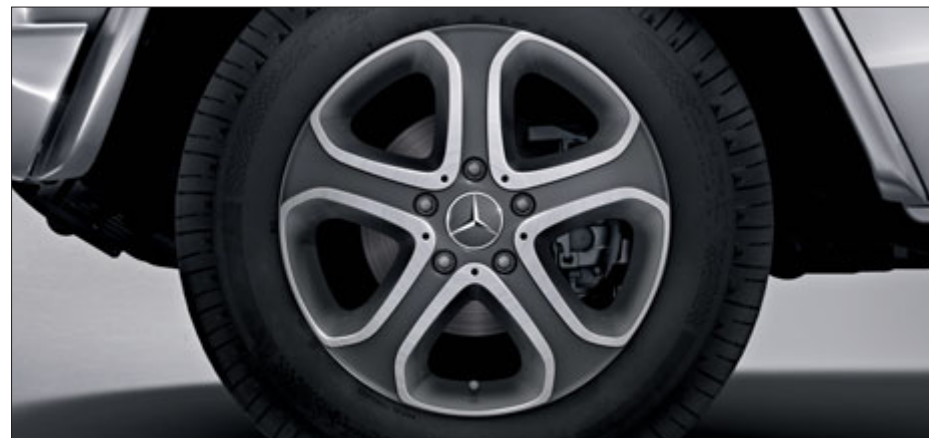
Llanta de aleación de 5 radios con neumáticos 265/60 R 18 en color gris titanio y pulida a alto brillo (opcional para G 350 BlueTEC, G 500, código RL5).
