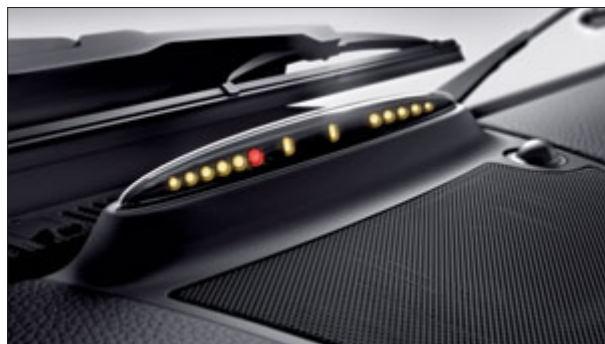
Los diodos luminosos de la ayuda para aparcar indican la separación respecto al obstáculo.
