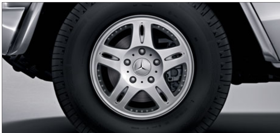
Llanta de aleación de 5 radios con neumáticos 265/70 R 16 (de serie para G 350 BlueTEC, código RL3).
