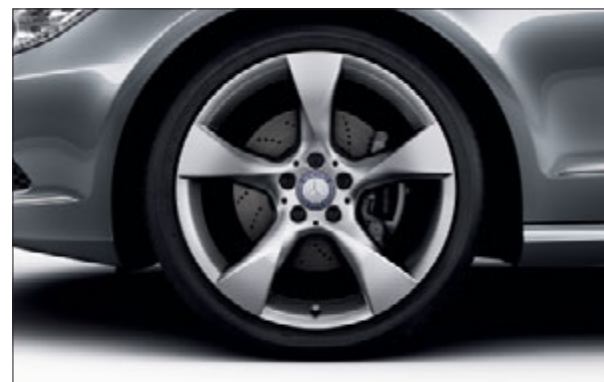
Kola z lehkých slitin v designu 5 loukotí ve stříbrném provedení s pneumatikami 255/35 R 19 vpředu a 285/30 R 19 vzadu (příplatková výbava pro sadu vnějších sportovních výbav, kód R82, v provedení Antracit kód R49).
