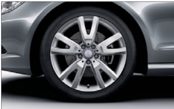
Kola z lehkých slitin v designu 5 dvouloukotí s pneumatikami 255/40 R 18 vpředu a 285/35 R 18 vzadu, lak Stříbrná Titan (příplatková výbava, kód R70).
