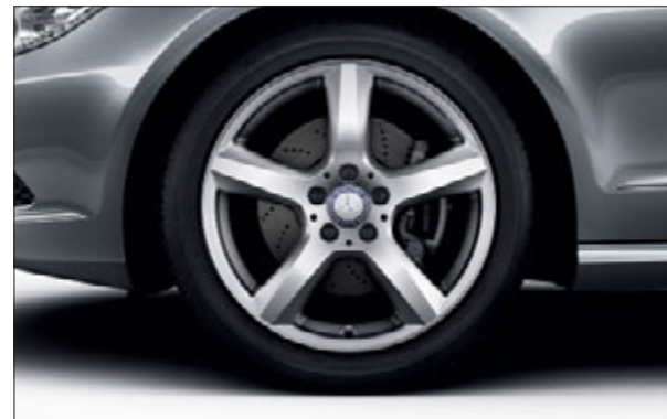
Kola z lehkých slitin v designu 5 loukotí ve stříbrném provedení s pneumatikami 255/40 R 18 vpředu a 285/35 R 18 vzadu (standard pro sadu vnějších sportovních výbav, kód R32, v provedení Antracit kód R36).
