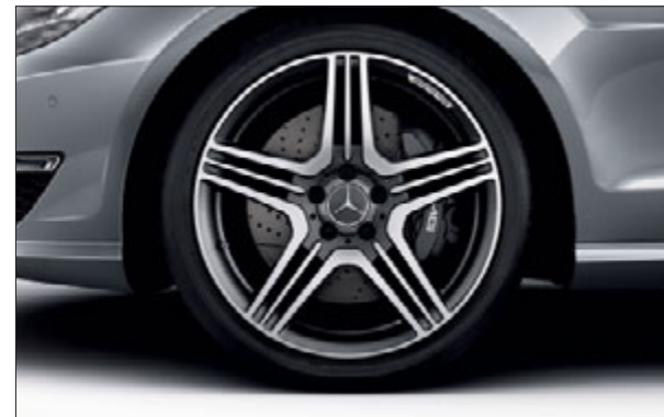
Kola AMG z lehkých slitin v designu 5 trojloukotí s pneumatikami 255/35 R 19 vpředu, 285/30 R 19 vzadu, lak šedá Titan, leštěná (standard pro CLS 63 AMG, kód 797).
