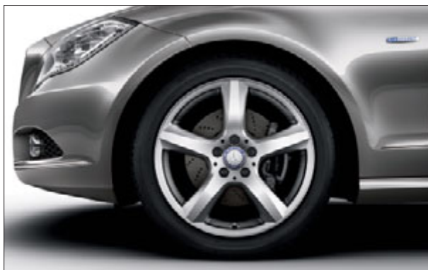
Kola z lehkých slitin v designu 5 loukotí, smíšené pneu 255/50 R 18 vpředu a 285/35 R 18 vzadu ve stříbrném provedení.
