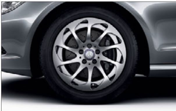
Kola z lehkých slitin v designu 10 loukotí s pneumatikami 245/45 R 17 (standard pro CLS 250 CDI BlueEFFICIENCY, kód R25).
