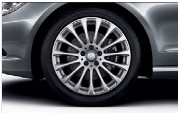
Kola z lehkých slitin, 15 loukotí, pneu 255/40 R 18 vpředu a 285/35 R 18 vzadu (příplatková výbava, kód R34).
