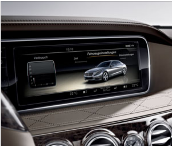
SPLITVIEW zeigt für Fahrer und Beifahrer gleichzeitig unterschiedliche Inhalte auf einem Bildschirm in der Mittelkonsole an.
