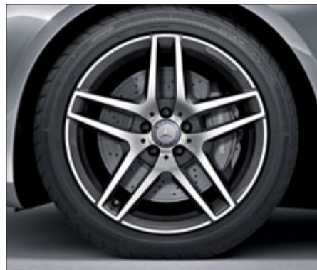
AMG Leichtmetallrad im 5-Doppelspeichen-Design, titangrau lackiert und glanzgedreht, mit Bereifung 245/45 R 19 vorne und 275/40 R 19 hinten (Serie für AMG Line, Code 793).
