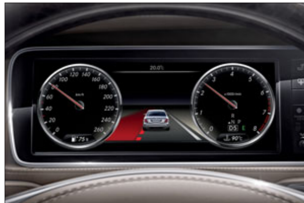
Der Aktive Spurhalte-Assistent kann bei unbeabsichtigtem Verlassen der Fahrspur kurskorrigierend eingreifen.
