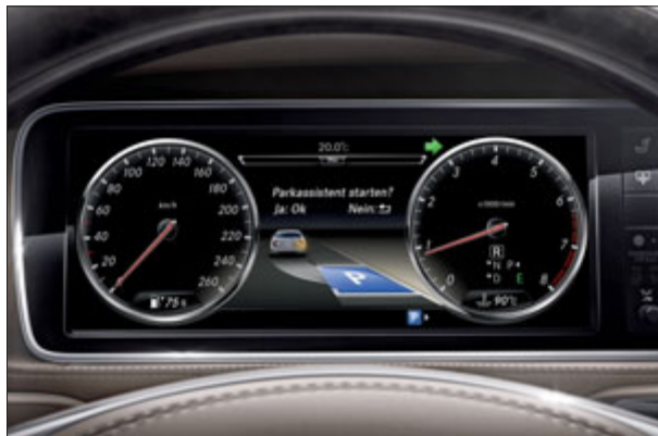
Die Stereokamera beobachtet einen Bereich von bis zu 500 Metern vor dem Fahrzeug und findet so auch Parklücken.
