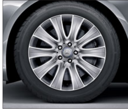
Leichtmetallrad im 10-Speichen-Design mit Bereifung 245/50 R 18 (Code R41).
