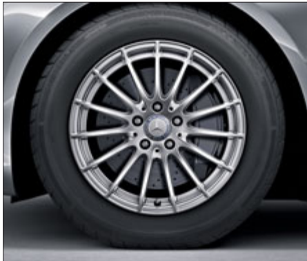
Leichtmetallrad im Vielspeichen-Design mit Bereifung 245/55 R 17 (Code 08R).
