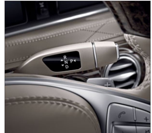
DIRECT SELECT Wählhebel am Lenkrad. Per zusätzlichen Schaltwippen kann der Fahrer auch manuell hoch- oder runterschalten.
