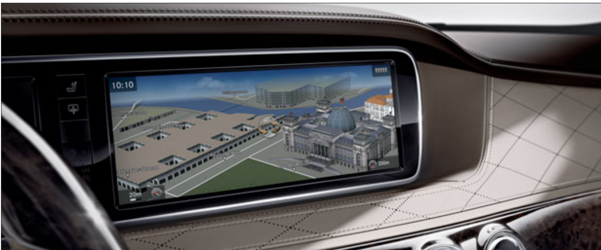
COMAND Online zeigt über ein hochauflösendes Farbdisplay alle Informations- und Kommunikationsfunktionen der neuen S-Klasse an.
