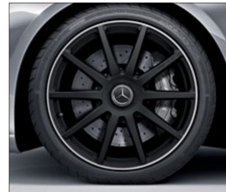
AMG Schmiederad im 10-Speichen-Design, mattschwarz lackiert, Felgenhorn glanzgedreht, mit Bereifung 255/40 R 20 vorne und 285/35 R 20 hinten (nur für S 63 AMG, Code 648).
