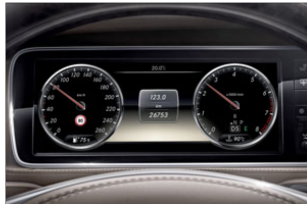
Der Verkehrszeichen-Assistent kann ausgeschilderte Tempolimits erkennen und die erkannte Höchstgeschwindigkeit im Display anzeigen.
