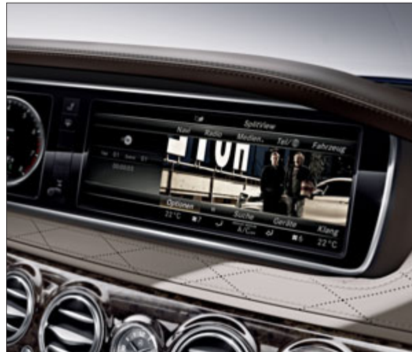
SPLITVIEW zeigt für Fahrer und Beifahrer gleichzeitig unterschiedliche Inhalte auf einem Bildschirm in der Mittelkonsole an.
