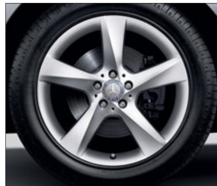
Kola z lehké slitiny v provedení s 5 loukotěmi, s pneumatikami 255/50 R 19, (příplatková výbava, vyjma ML 63 AMG, kód R39).
