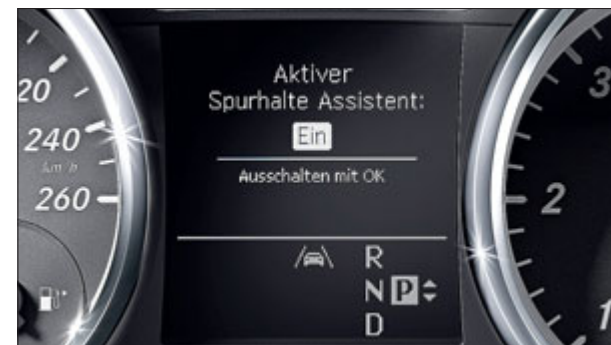
Varuje před neúmyslnou změnou jízdního pruhu a když je potřeba, upraví směr: aktivní asistent jízdy v pruzích.
