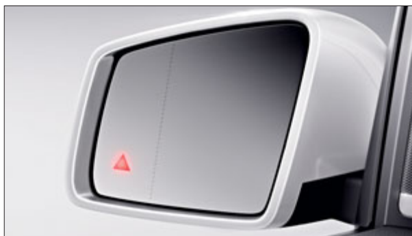
Aktivní asistent hlídání mrtvého úhlu varuje při změně jízdního pruhu a nouzově přibrzdí vozidlo.
