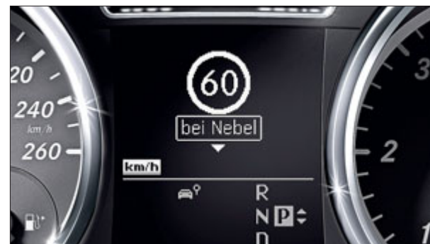
Indikace asistenta rychlostního omezení jsou zobrazeny jak na sdruženém přístroji, tak na centrálním displeji systému COMAND Online.
