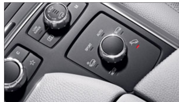
Jízdní program se nastavuje pomocí otočného spínače na středové konzole.
