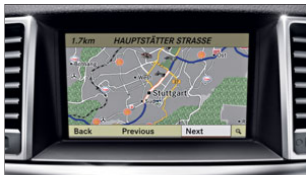
Multimediální systém s navigačním systémem na pevném disku má k dispozici barevný displej vysokého rozlišení s úhlopříčkou 17,8 cm.
