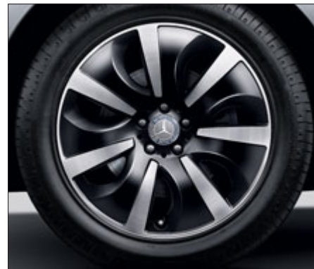
Kola z lehké slitiny v provedení se 7 loukotěmi, s pneumatikami 255/50 R 19, leštěná (příplatková výbava, vyjma ML 63 AMG, kód 06R).
