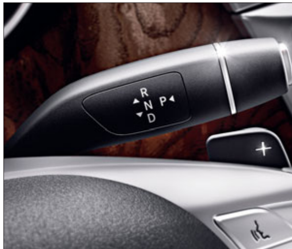
Ovládání převodovky pomocí volicí páky DIRECT SELECT na sloupku řízení. Řidič může zároveň ovlivnit řazení pomocí řadicích pádel pod volantem.
