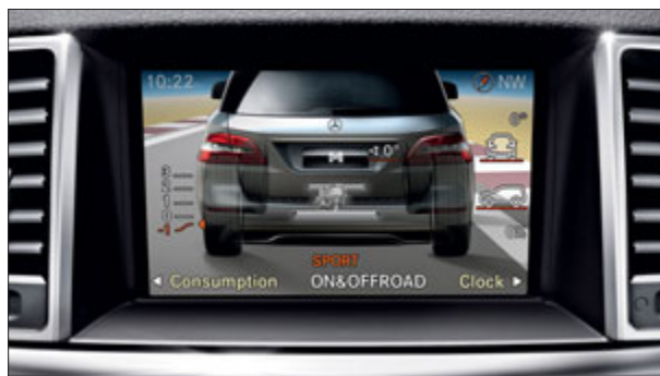
Na displeji COMAND je zobrazen jízdní program a ukazatel stoupání či úhlu sklonu.
