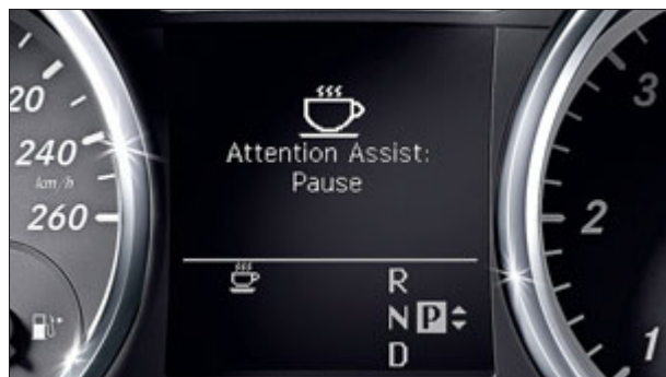
Při rozpoznání známek únavy řidiče doporučí ATTENTION ASSIST přestávku.
