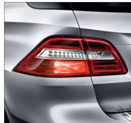
Koncová světla s LED a optickými vlákny.
