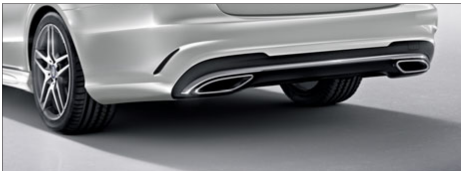
Equipo de escape de doble flujo con salidas rectangulares cromadas integradas en el paragolpes.
