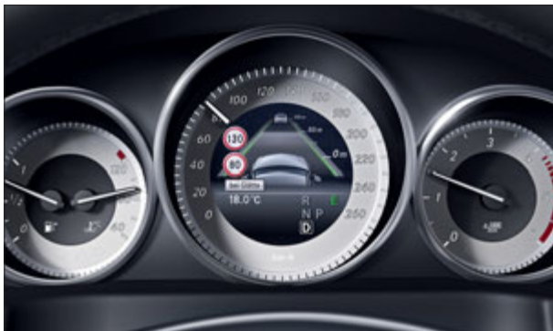
El detector de señales de tráfico visualiza en el display el límite de velocidad y las prohibiciones que rigen en el momento.
