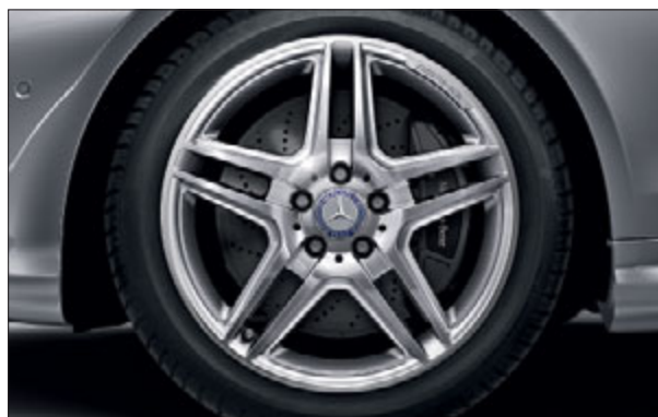
Llanta de aleación AMG de 5 radios dobles pulida a alto brillo con neumáticos 235/40 R 18 delante y 255/35 R 18 detrás, (opcional, código 795).
