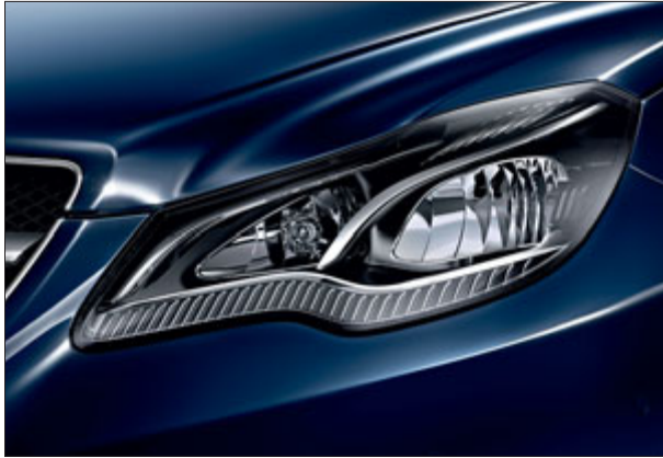
Técnica parcial de diodos luminosos: faro principal y luz diurna LED.
