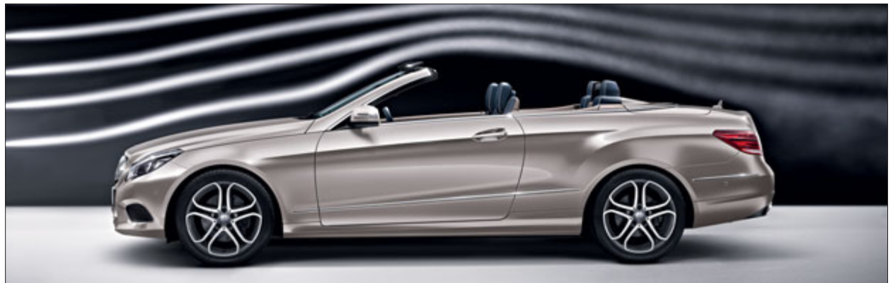
Inteligente: AIRCAP desvía la corriente de aire por encima de los cuatro ocupantes del vehículo.
