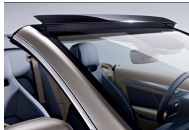
AIRCAP con lama deflectora eléctrica (sólo para cabrio).
