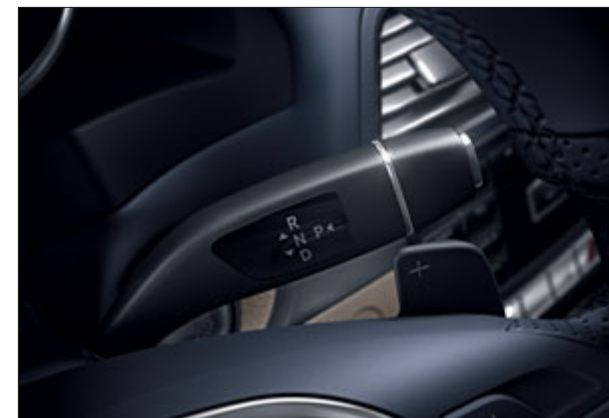
Palanca selectora DIRECT SELECT y levas de cambio en el volante.
