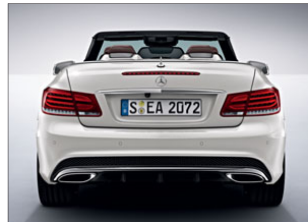
El paquete deportivo AMG ofrece un equipo de escape de doble flujo y embellecedores trapezoidales de acero inoxidable pulido en el paragolpes.
