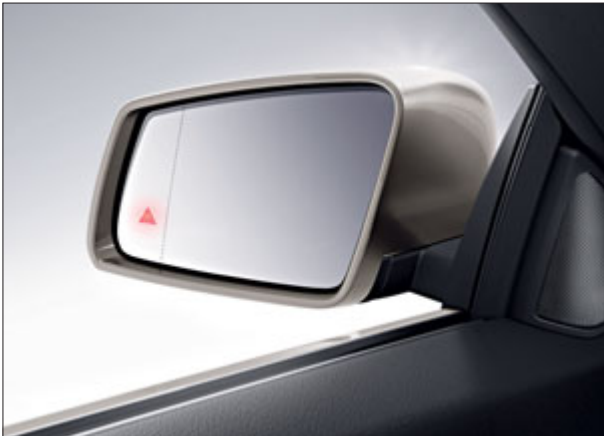
El detector de cambio de carril y el control de ángulo muerto pueden prevenir al conductor de posibles situaciones peligrosas, por ejemplo al cambiar de carril.
