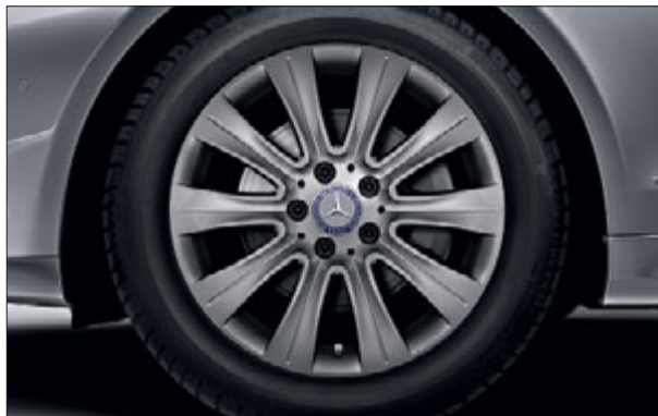
Llanta de aleación de 10 radios con neumáticos 235/45 R 17 (opcional para modelos de 4 y 6 cilindros, código 25R).
