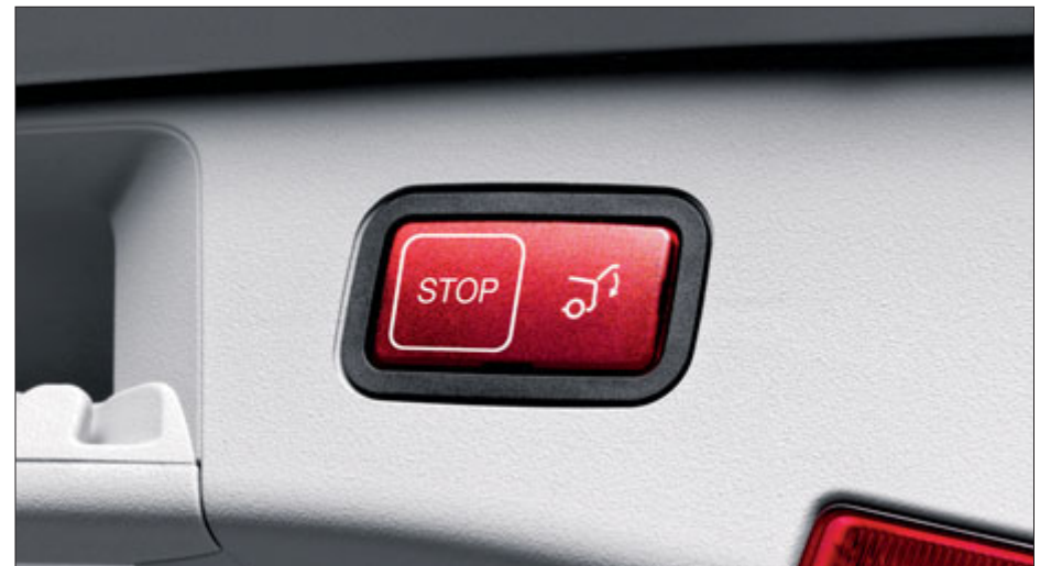
Die EASY-PACK Heckklappe können Sie per Knopfdruck auch in einer niedrigen Stellung öffnen und schließen.
