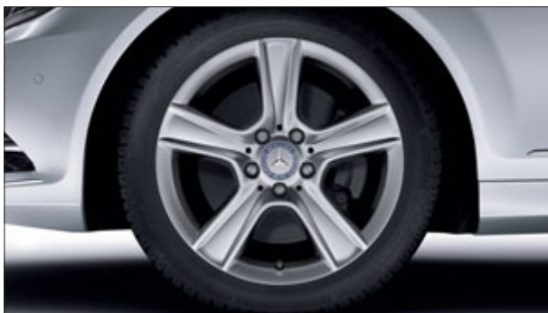
Leichtmetallrad Proserpina im 5-Speichen-Design mit Bereifung 225/45 R 17 vorne und 245/40 R 17 hinten, in Sterlingsilber lackiert.
