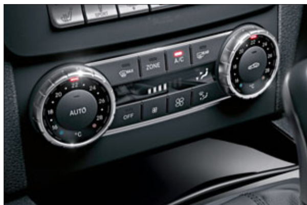
Die THERMATIC arbeitet auf Basis von Sensorinformationen, die Daten über die Innen- und Außentemperatur sowie über die Luftfeuchtigkeit enthalten.
