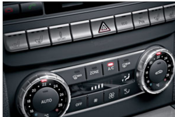
Belüftung und Beheizung der Sitzklimatisierung lassen sich unabhängig voneinander einstellen.
