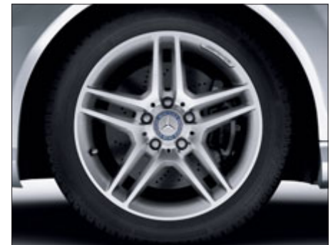
AMG Leichtmetallrad im 5-Doppelspeichen-Design mit Bereifung 225/45 R 17 vorne und 245/40 R 17 hinten, glanzgedreht (Bestandteil des optionalen Sport-Pakets AMG, nicht für C 63 AMG, Code 784).
