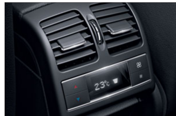
Mit der separaten Bedieneinheit im Fond können Wunschttemperatur und Luftmenge präzise eingestellt werden.
