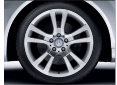
Leichtmetallrad im 5-Doppelspeichen-Design mit Bereifung 225/40 R 18 vorne und 255/35 R 18 hinten (optional, Code R70).
