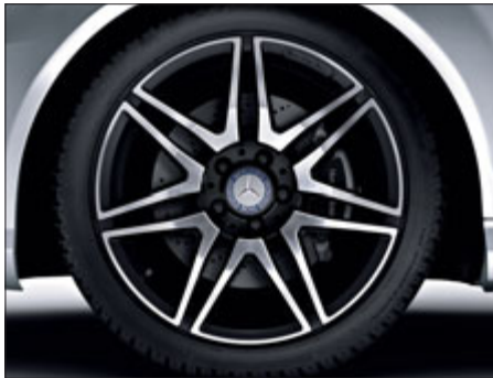
AMG Leichtmetallrad im 7-Doppelspeichen-Design mit Bereifung 225/40 R 18 vorne und 255/35 R 18 hinten, in Hochglanzschwarz lackiert und glanzgedreht (Serie Sport-Paket AMG Plus, Code 760).
