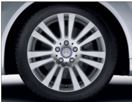
Leichtmetallrad im 7-Doppelspeichen-Design mit Bereifung 205/55 R 16 (Code R27) 3 oder 225/45 R 17 (Code 26R) 4 .
