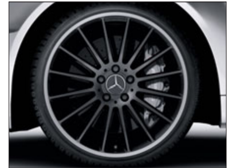
AMG Leichtmetallrad im Vielspeichen-Design mit Bereifung 235/35 R 19 vorne und 255/30 R 19 hinten, in Mattschwarz lackiert und Felgenhorn glanzgedreht (optional für C 63 AMG, Code 797).
