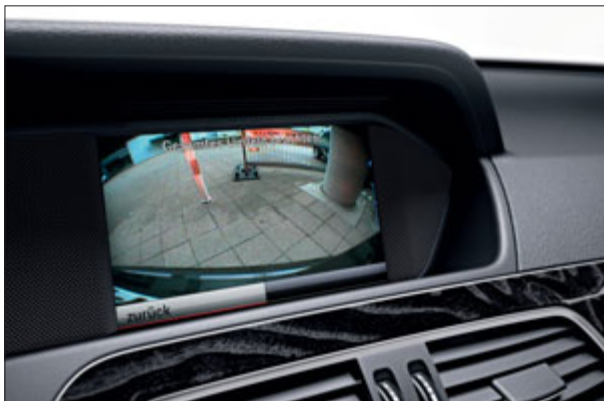
Die Rückfahrkamera gibt eine zusätzliche Hilfestellung beim rückwärtigen Einparken.
