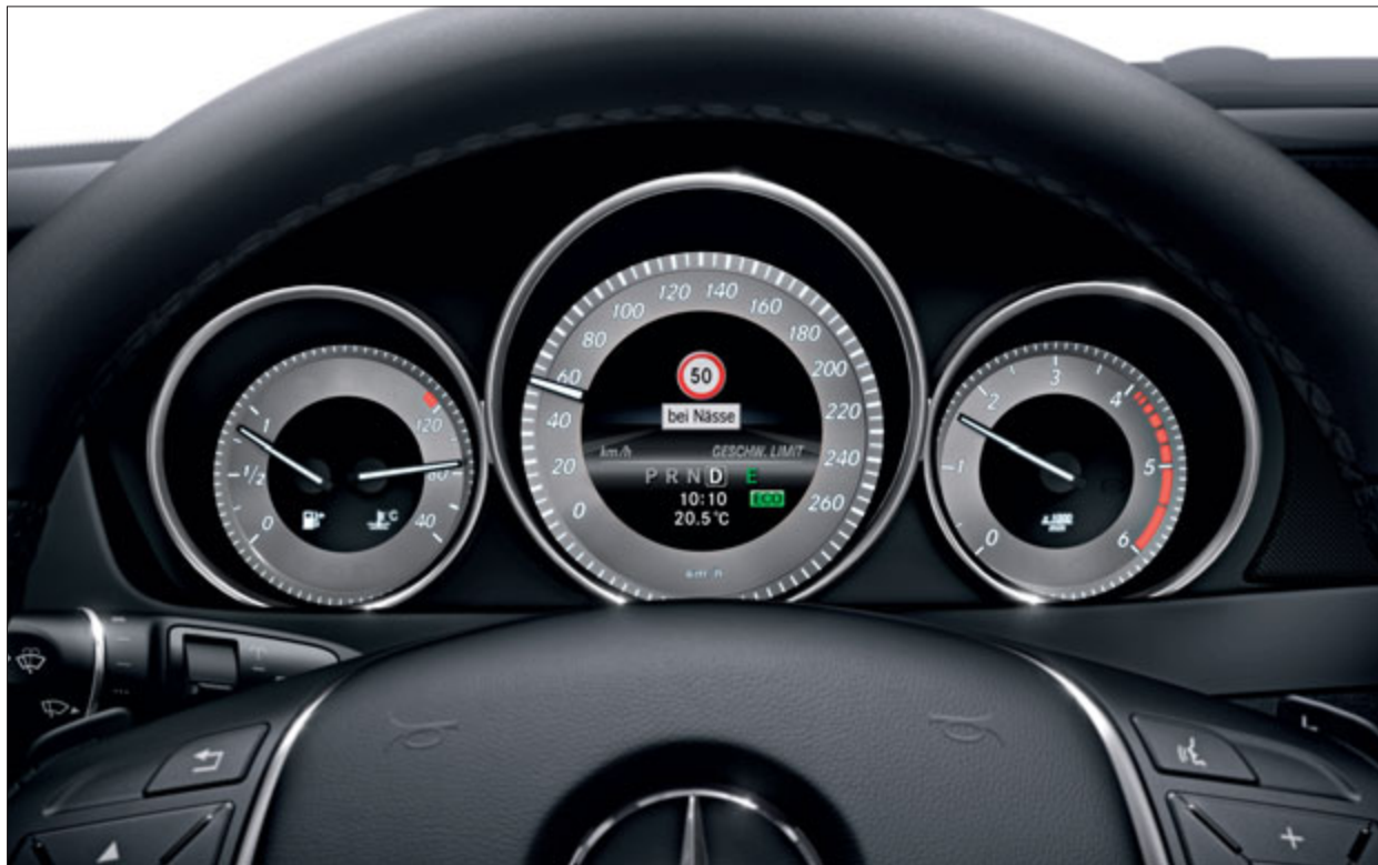
Der Geschwindigkeitslimit-Assistent kann auch temporäre Geschwindigkeitsbeschränkungen anzeigen.
