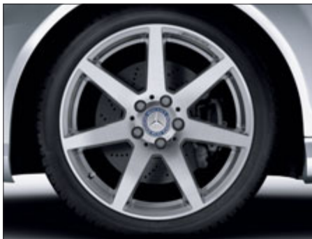
AMG Leichtmetallrad im 7-Speichen-Design mit Bereifung 225/40 R 18 vorne und 255/35 R 18 hinten, glanzgedreht (optional, nicht für C 63 AMG, Code 782).
