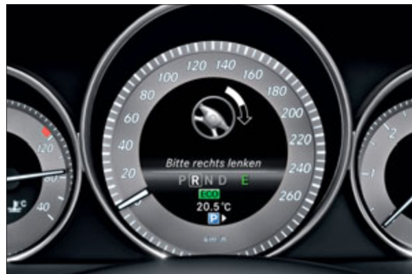
Das Display im Kombiinstrument gibt Ihnen jederzeit einen Überblick über den aktuellen Parkvorgang.
