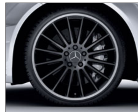
AMG Leichtmetallrad im Vielspeichen-Design, in Mattschwarz lackiert und Felgenhorn glanzgedreht, mit Bereifung 235/35 R 19 vorne und 255/30 R 19 hinten (optional für C 63 AMG, Code 797).
