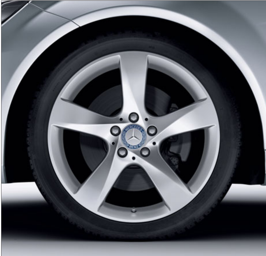
Leichtmetallrad im 5-Speichen-Design mit Bereifung 225/40 R 18 vorne und 255/35 R 18 hinten, in Sterlingsilber lackiert (optional, Code R36).
