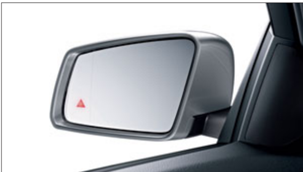
Der Totwinkel-Assistent kann akustisch und mittels eines roten Warndreiecks im Außenspiegel vor möglichen Gefahren warnen.
