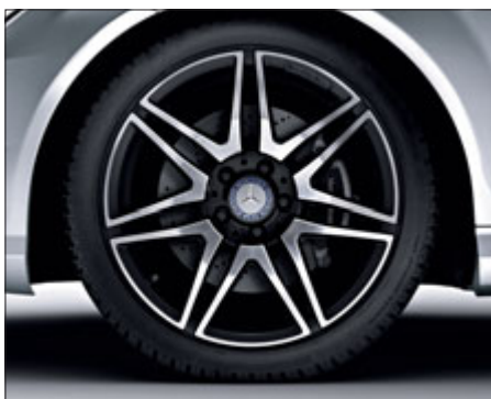
AMG Leichtmetallrad im 7-Doppelspeichen-Design mit Bereifung 225/40 R 18 vorne und 255/35 R 18 hinten, in Hochglanzschwarz lackiert und glanzgedreht (Serie Sport-Paket AMG Plus und Sport-Modelle, Code 760).
