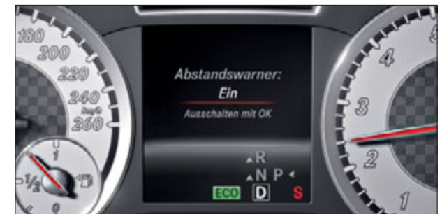
El sistema COLLISION PREVENTION ASSIST puede detectar una distancia de seguridad insuficiente y advertir al conductor.
