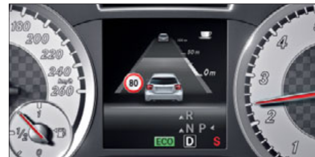
El indicador de velocidad límite informa al conductor en el cuadro de instrumentos y en el display central de COMAND Online.
