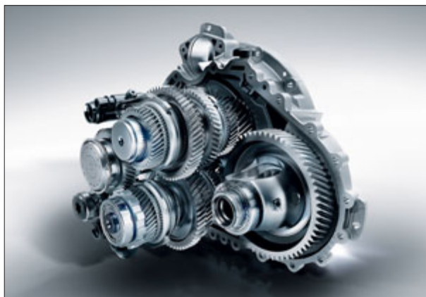
7G-DCT permite cambios de relación sin interrupción de la fuerza de tracción.
