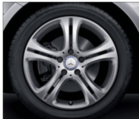
Llanta de aleación de 5 radios dobles con neumáticos 225/45 R 17 (código R11; de serie con Urban).
