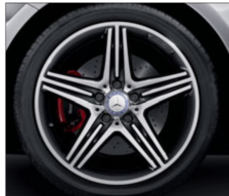
Llanta de aleación AMG de 5 radios, color negro y acabado brillante, con neumáticos 235/40 R 18 (código 774; de serie para A 250 Sport).
