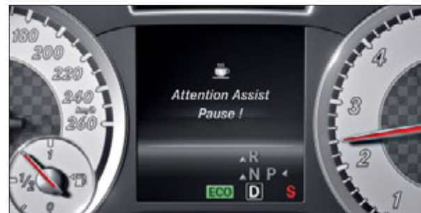
ATTENTION ASSIST recomienda hacer un descanso si detecta síntomas de fatiga en el conductor.
