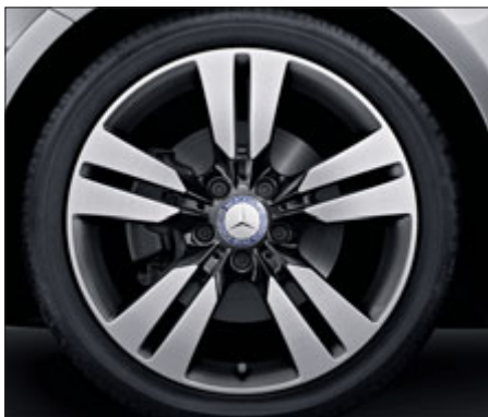
Llanta de aleación de 5 radios dobles, en color negro, pulida a alto brillo, con neumáticos 225/40 R 18 (código R38; de serie para paquete Night con Style o Urban).
