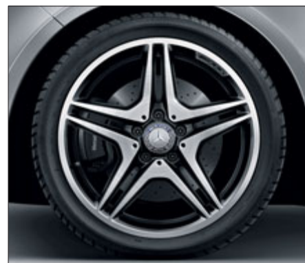
Jante alliage AMG à 5 doubles branches avec pneus 225/40 R 18, finition noir et naturel brillant (série sur Fascination, code 781).
