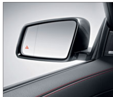
Pack d'assistance à la conduite avec avertisseurs de franchissement de ligne et d'angle mort. 1
