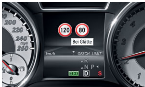
Le rappel de limitation de vitesse s'affiche sur le combiné d'instruments et sur l'écran central du système COMAND Online.
