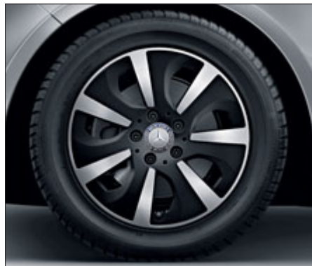
Jante alliage à 7 branches avec pneus 205/55 R 16, finition noir mat et naturel brillant (série sur CLA 180 BlueEFFICIENCY Edition, code R20).
