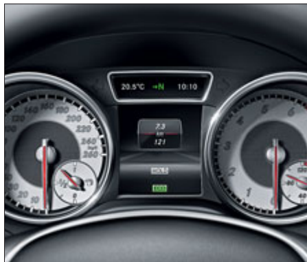
Combiné d'instruments à doubles cadrans cylindriques avec écran couleur TFT multifonctions.
