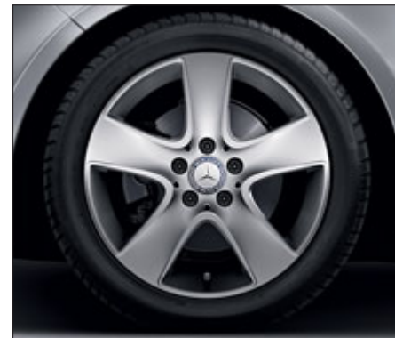
Jante alliage à 5 branches avec pneus 225/45 R 17, finition argent titane (série sur Inspiration, code R24) 1 .
