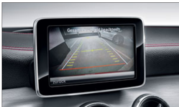
La caméra de recul assiste le conducteur lors des manœuvres de stationnement.
