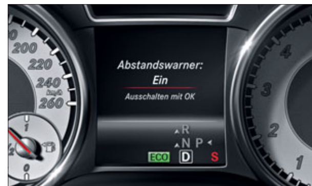
COLLISION PREVENTION ASSIST puede avisar al conductor con una señal óptica y acústica si la distancia de seguridad se reduce peligrosamente.
