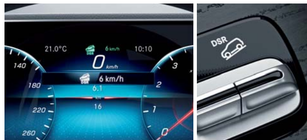
急勾配の下り走行でも車速を自動制御する DSR(ダウンヒル・スピード・レギュレーション)
