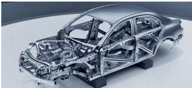
高度な安全性と快適性の強固な土台となる 軽量・高剛性ボディ
