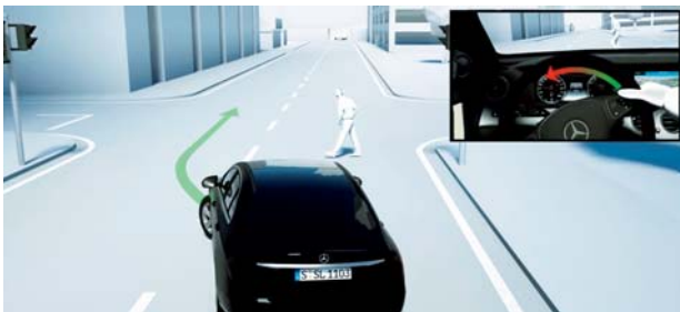
危険な状況の回避操作が安心して行える 緊急回避補助システム
