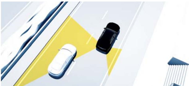
車線変更時のうっかりをカバーしてくれる アクティブブラインドスポットアシスト
