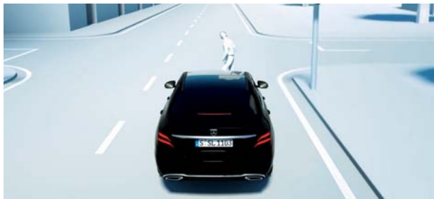
前走車や歩行者との衝突回避をアシストする アクティブブレーキアシスト (歩行者／飛び出し検知機能付)
