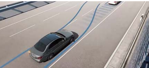
ウインカーを点滅させるだけで車線変更できる アクティブレーンチェンジングアシスト
