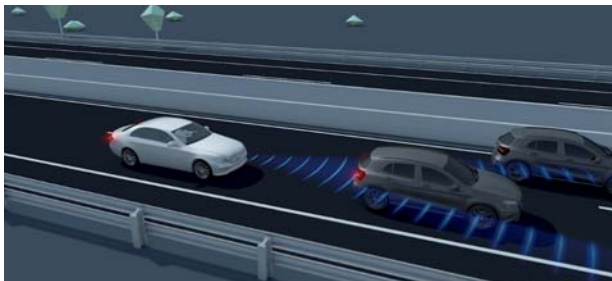
ふいに現れた渋滞後尾への衝突回避を図る 渋滞時緊急ブレーキ機能
