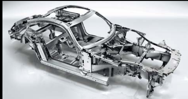
圧倒的なダイナミクスのための 軽量・高剛性なアルミニウムスペースフレーム
