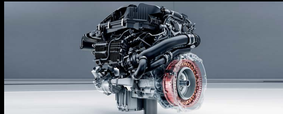
アクセルを踏むたびに歓びが溢れ出すドライビングが体験できる 3.0ℓ直列6気筒直噴ターボエンジン+ISG
